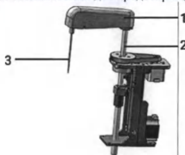
Рисунок 7 – Схематическое обозначение механизма забора реагентов (обозначение основных конструктивных элементов): 1 – рычаг; 2 – ротор; 3 – зонд реагентов.
