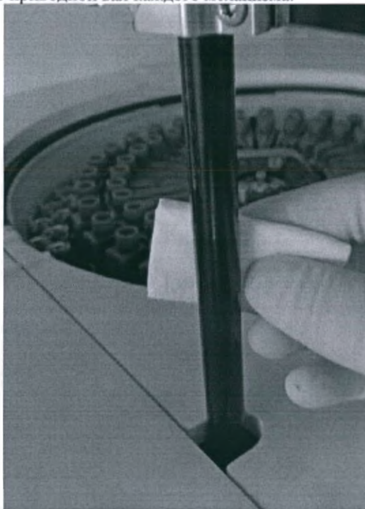
Рисунок 168 – Очистка приводного вала механизма забора проб и приводного вала механизма забора реагентов
