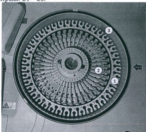
Рисунок 4 – Внешний вид Диск проб/реагентов: 1 – диск проб (позиции для установки пробирок с пробами); 2 – диск реагентов (позиции для установки флаконов с реагентами); 3 – сканер штрих-кода проб.
