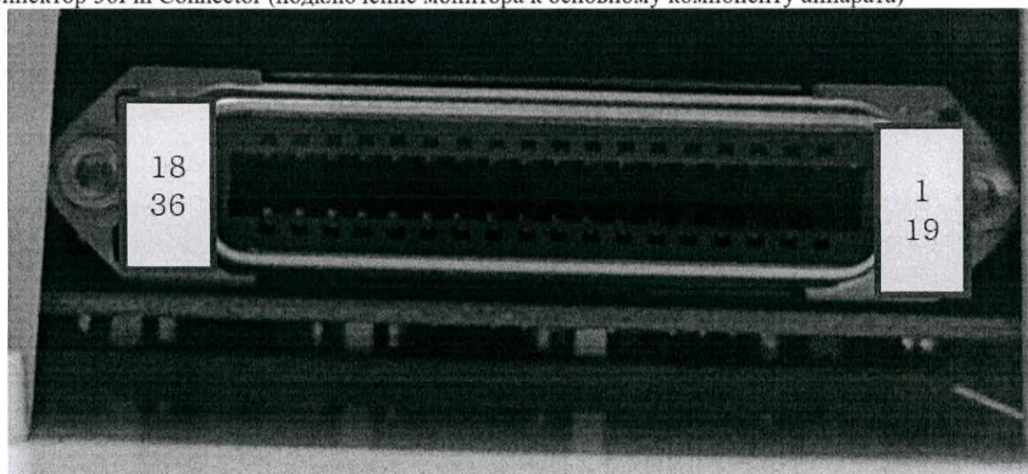
(1) Коннектор 36Pin Connector (подключение монитора к основному компоненту аппарата)
