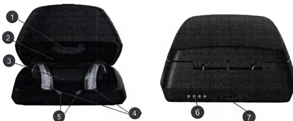
Рисунок 3 – Зарядное устройство: 1 – отсек для влагопоглотителя, 2 – щетка для очистки, 3 – отсек для наушников/ушных вкладышей, 4 – порты для зарядки, 5 – светодиоды зарядки слухового аппарата, 6 – наружные светодиоды зарядки аккумулятора, 7 – разъем micro-USB
