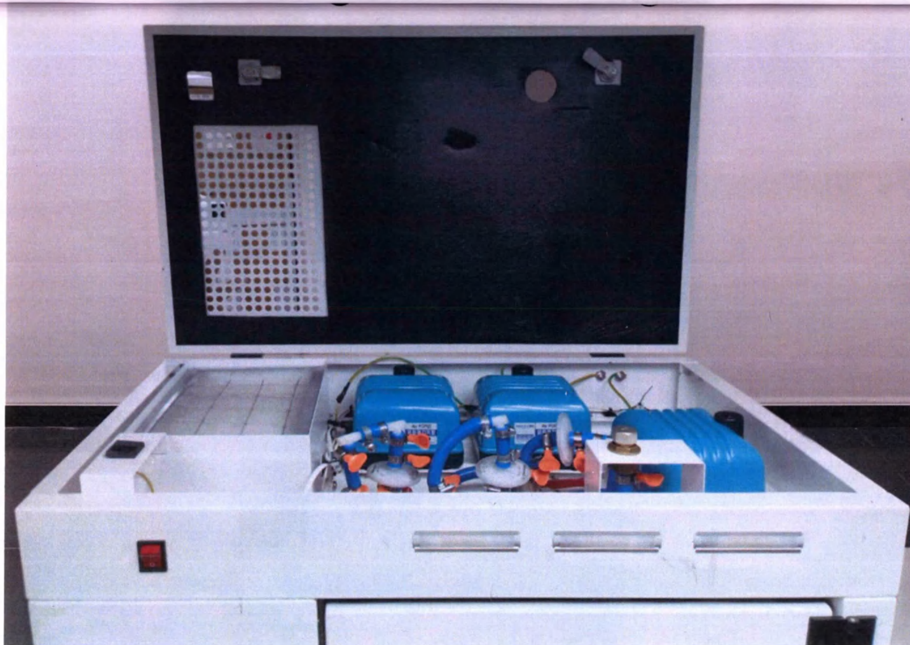
Фотографическое изображение №9. Шкаф для сушки и хранения гибких эндоскопов «КЛИНСКОПБОКС», КЛИНСКОПБОКС-3. Открыта верхняя крышка технического отсека.
