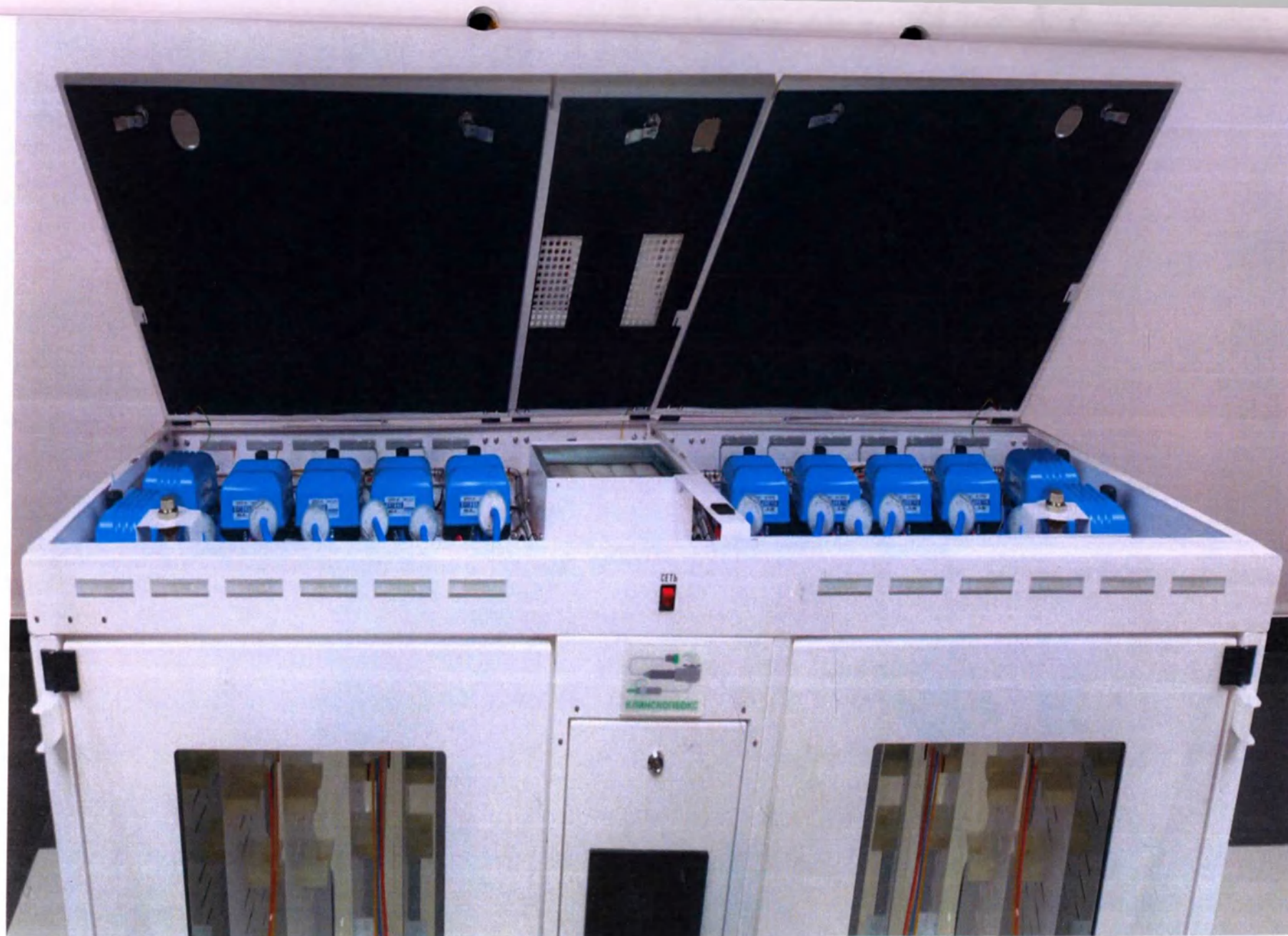
Фотографическое изображение №53. Шкаф для сушки и хранения гибких эндоскопов «КЛИНСКОПБОКС», КЛИНСКОПБОКС-12ПРО. Открыта верхняя крышка технического отсека.
