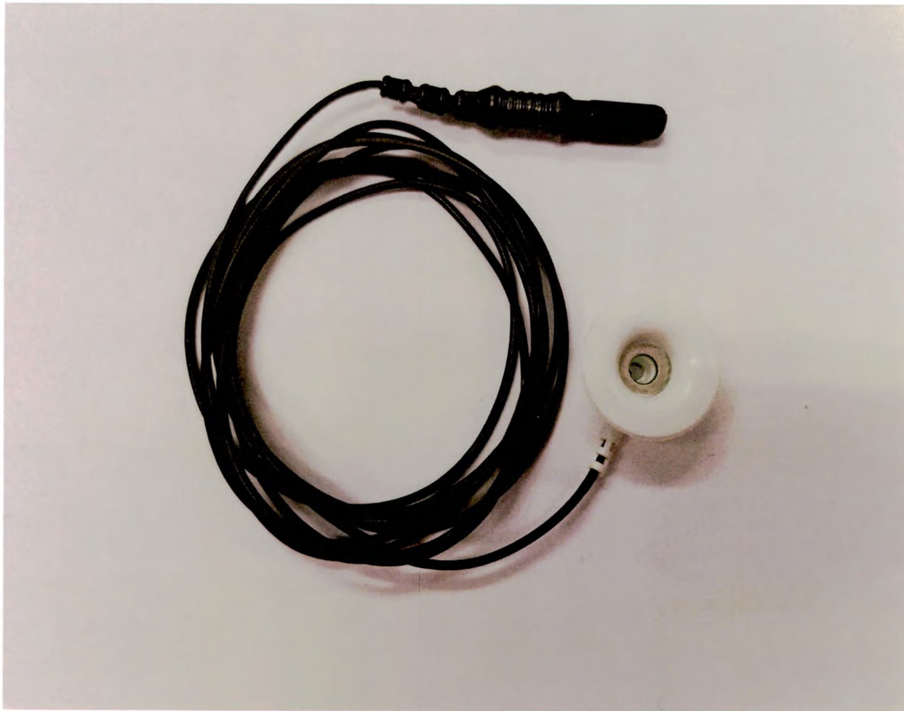
Рисунок 1.2 Электрод электроэнцефалографический MCScar-C – сенсор
