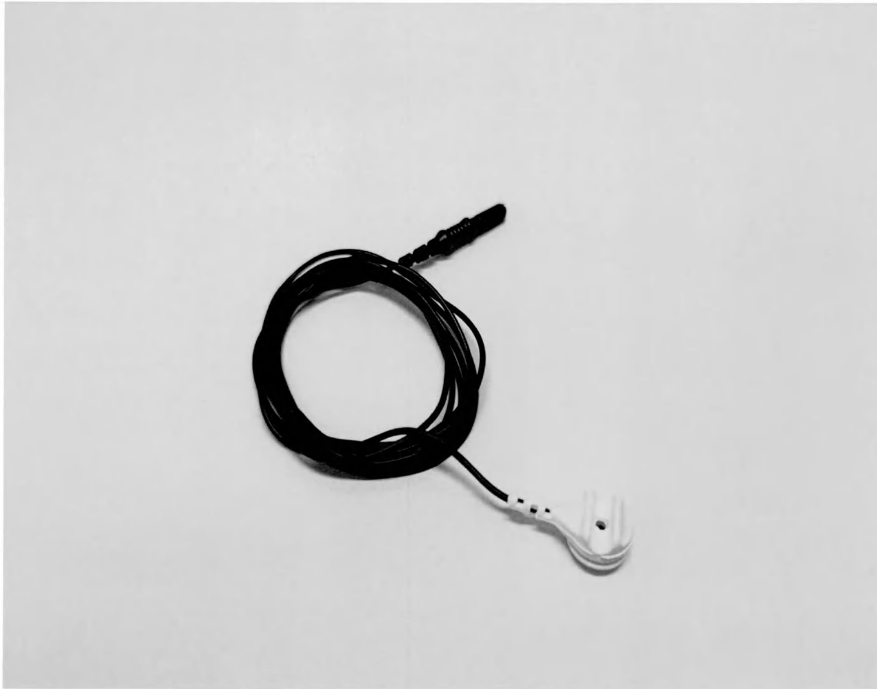
Рисунок 9.1 Электрод электроэнцефалографический MCSap-StTC – общий вид
