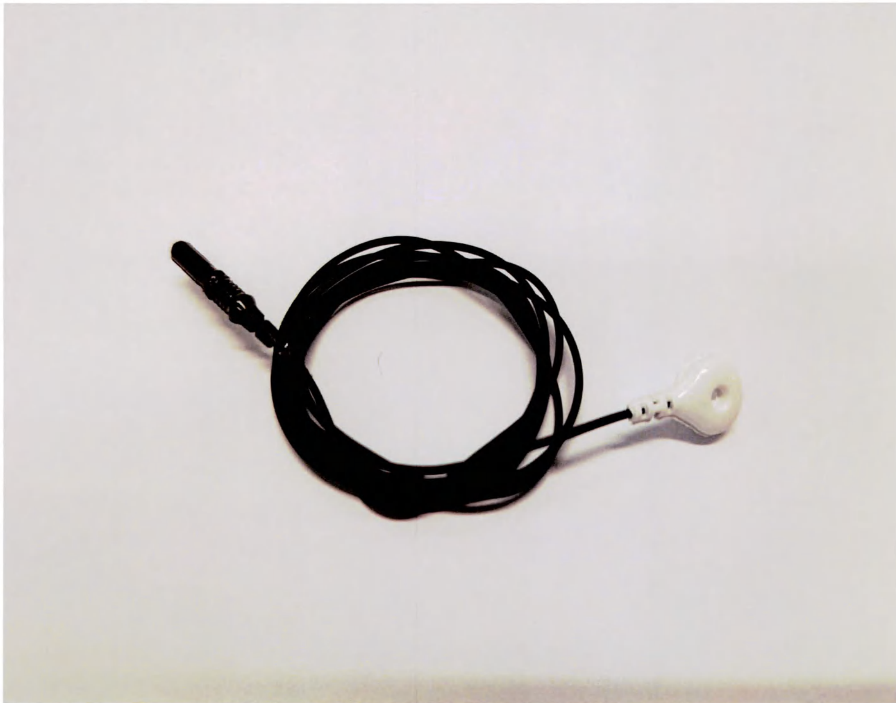
Рисунок 3.1 Электрод электроэнцефалографический MCScar-TC – общий вид
