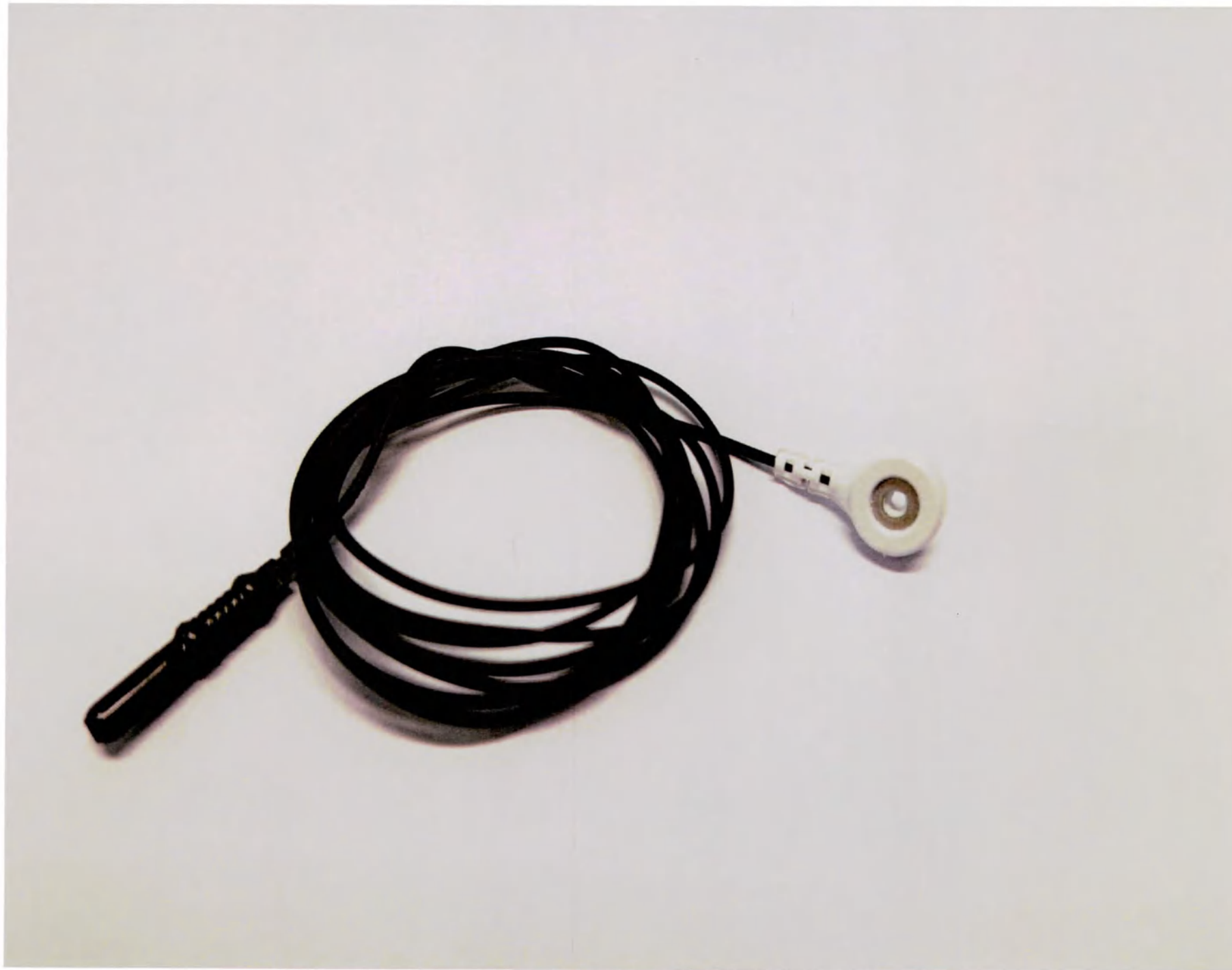
Рисунок 3.2 Электрод электроэнцефалографический MCSap-TC – сенсор
