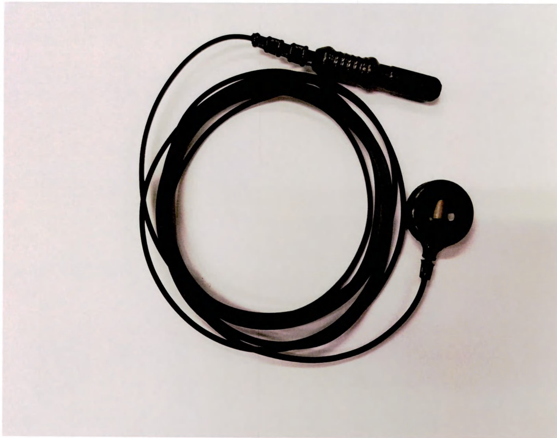
Рисунок 2.2 Электрод электроэнцефалографический MCSap-T – сенсор
