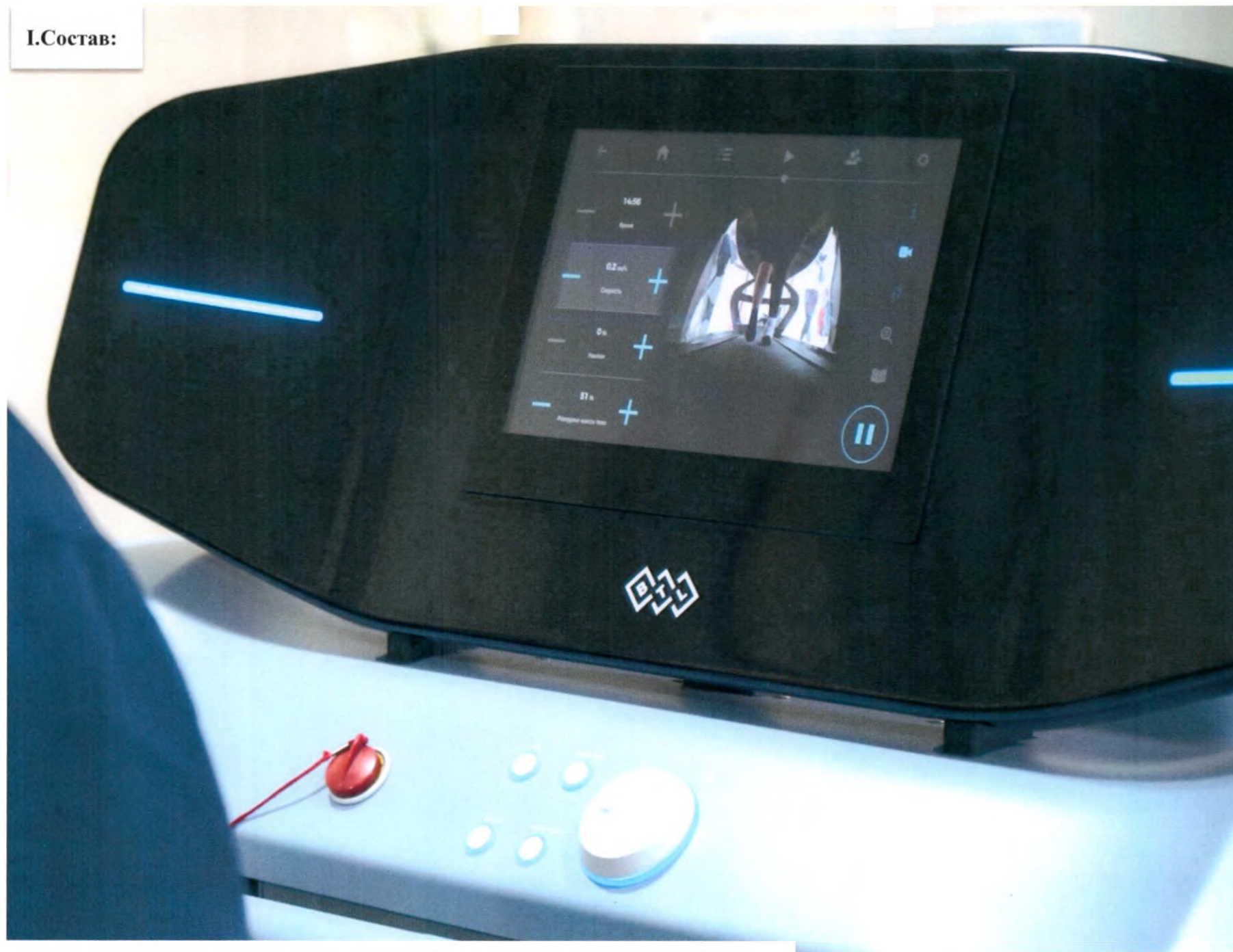
1.1. Панель управления и сенсорный экран Антигравитационной беговой дорожки для реабилитации с принадлежностями, модель R-FORCE Elite
