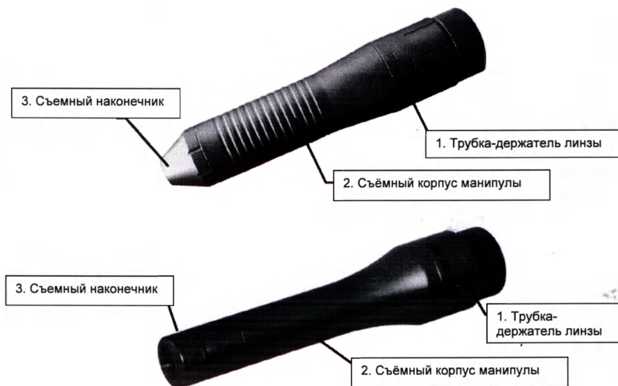
Рис. 1. Коллимирующая оптическая Er:YAG манипула модели R09-2 (сверху), R09-T (снизу).
