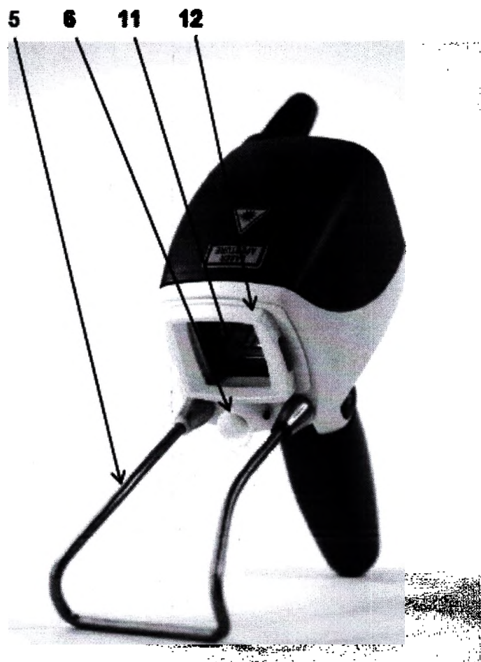
Рисунок 5.2. Компоненты сканера Fotona S-11 Nd:YAG (с коротким спейсером)
