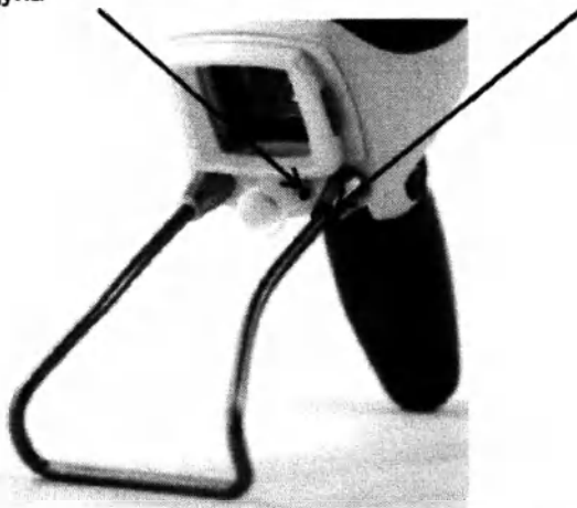
Рисунок 5.5. Красная точка на сопле холодного воздуха должна быть направлена вправо, к красному кольцу на коротком спейсере
