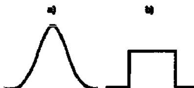
Рисунок 6.3: а) Профиль гауссова луча, б) Профиль цилиндрического луча Top-hat
