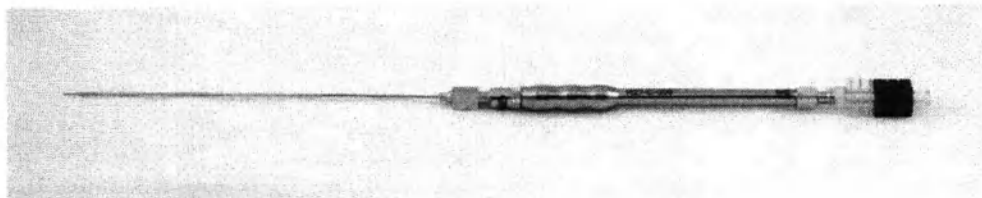
Рис. 10: Полностью собранная манипула с оптоволоком и одноразовой иглой с наконечником Люэра.
