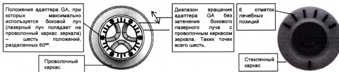
Рисунок 8: Гравировка на входной поверхности спекулум для углового позиционирования лазерного луча с адаптером GA.
