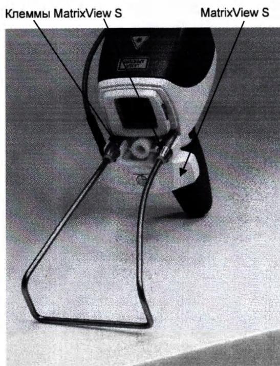
Рисунок 6.3: Подключение MatrixView S к длинному спейсеру.
