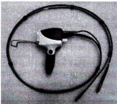
Рисунок 4.1: Кабель сканера вместе с волоконной системой доставки луча.
