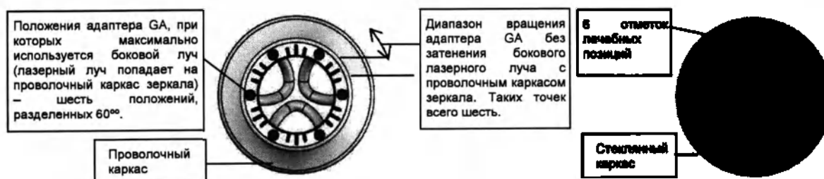
Рисунок 11: Гравировка на входной поверхности спекулам для углового позиционирования лазерного луча с адаптером GA.
