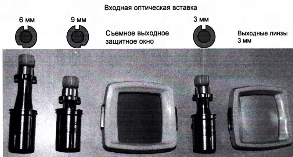
Рисунок 5.4. Выбор входной и выходной оптики для различных размеров пятна сканера
