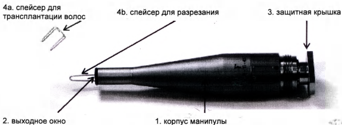
Рис. 1. Оптическая Er:YAG манипула R08-Ti
