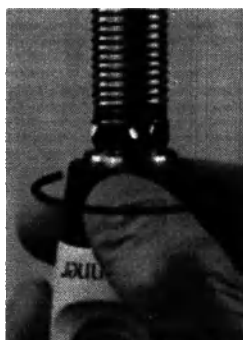
Рисунок 6.19: Вращайте фиксирующую гайку по часовой стрелке до тех пор, пока переходник не начнет вращаться вместе с гайкой.
