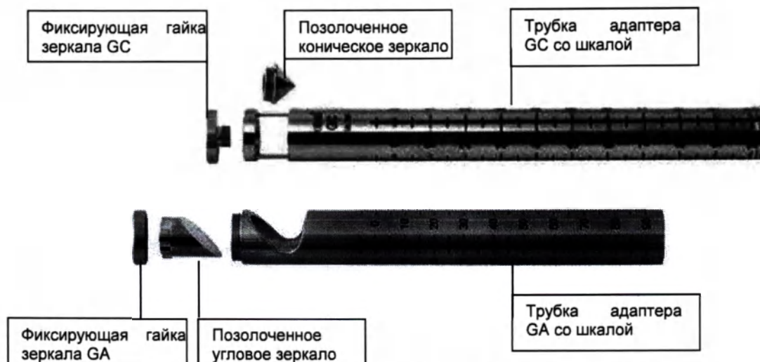
Рисунок 8: Разбивка адаптера Fotona модели GA и GC.
