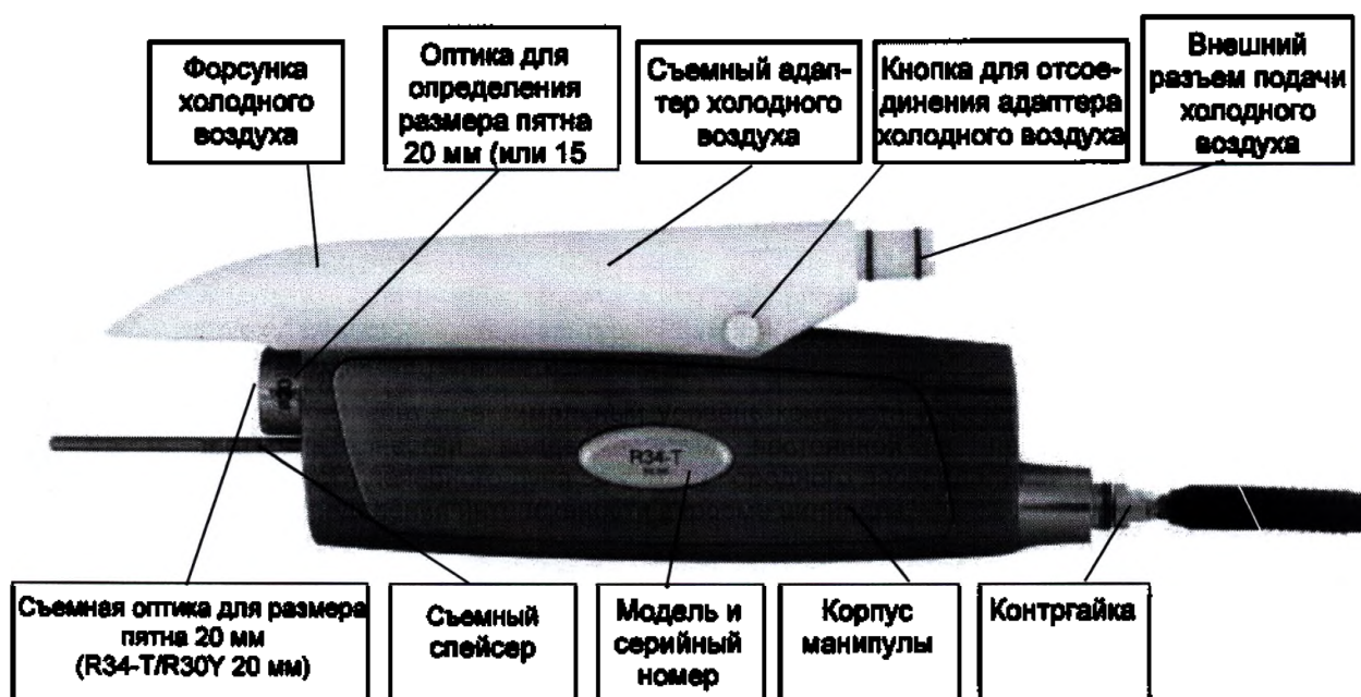
Рис. 4.1: Манипула R34-T/R30Y с прикрепленным адаптером холодного воздуха
