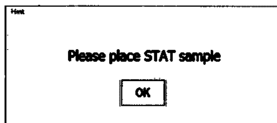
Рис. 4-24. Аварийный сигнал в случае отсутствия STAT-пробы в отсеке
