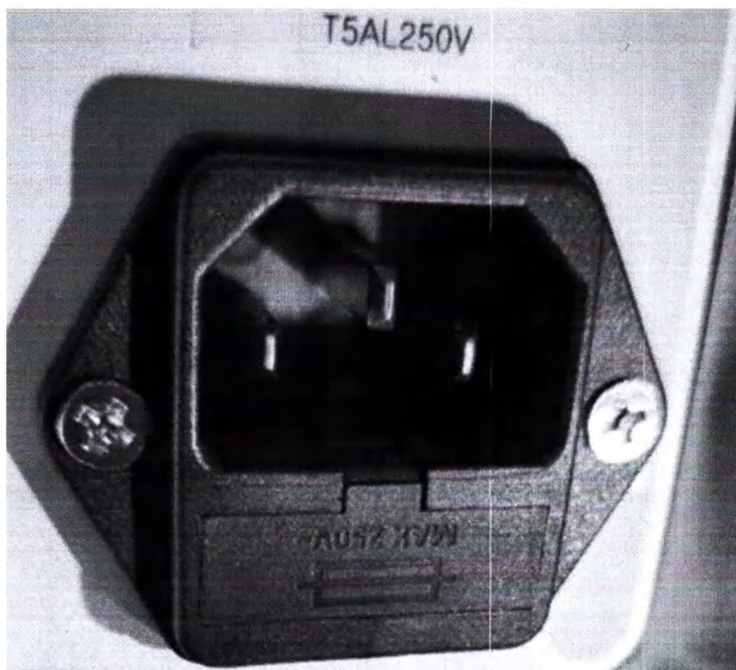
Изображение 3. Расположение предохранителя и его маркировка
