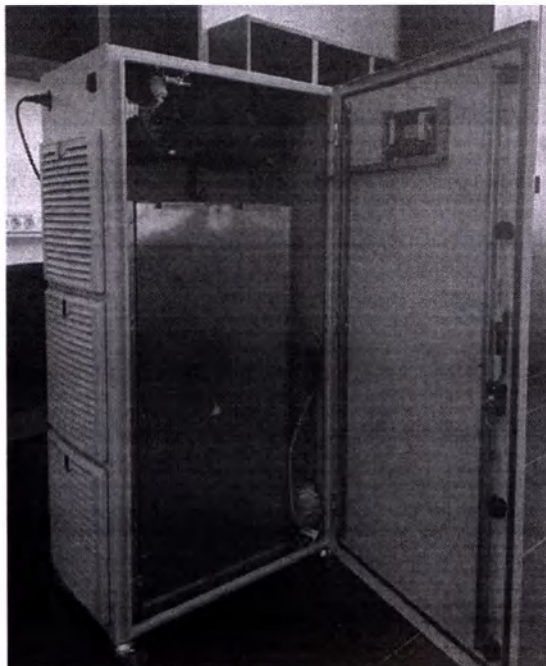
Рисунок 6.4 – Внешний вид фильтра воздушного G4/ F5: а) внутренняя сторона фильтра воздушного G4/ F5; б) вид сбоку
