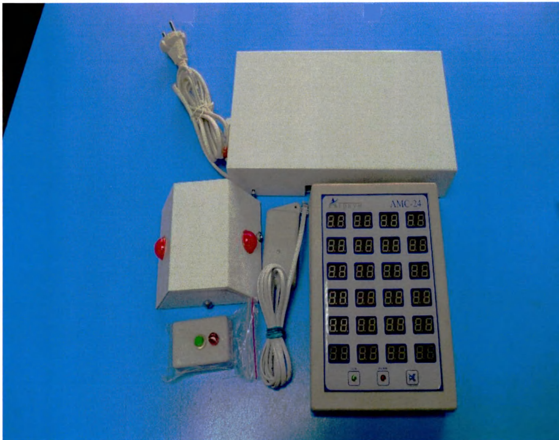
1.2 Палатная сигнализация AMC: AMC 96, AMC 48, AMC 24, AMC 12, производства ЗАО «АТРИУМ», Россия
