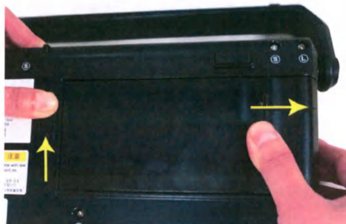
Рис. 1-10. Открытие защелки и сдвиг аккумулятора
