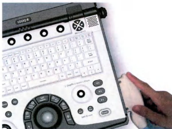
Рис. 1-47. Подсоединение датчика к системе LOGIQ e
