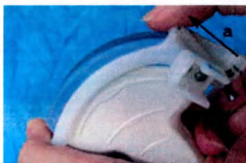
Рис. 5-31. Снимите направляющую для биопсии
