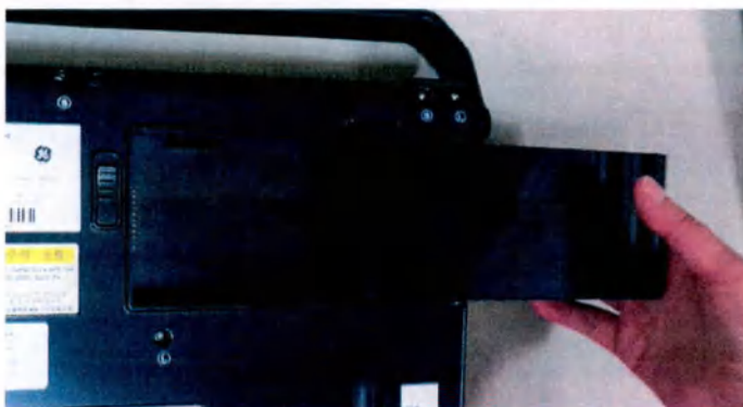
Рис. 1-12. Установка аккумулятора под нижнюю крышку
