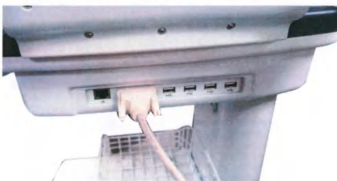
Рис. 1-20. Подключение кабеля DVI
