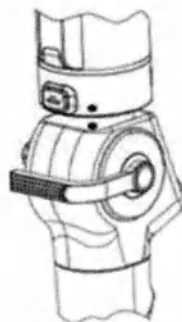
Рис. 3.9 Подключение беспроводного передатчика и соединительного кабеля к эндоскопу.
