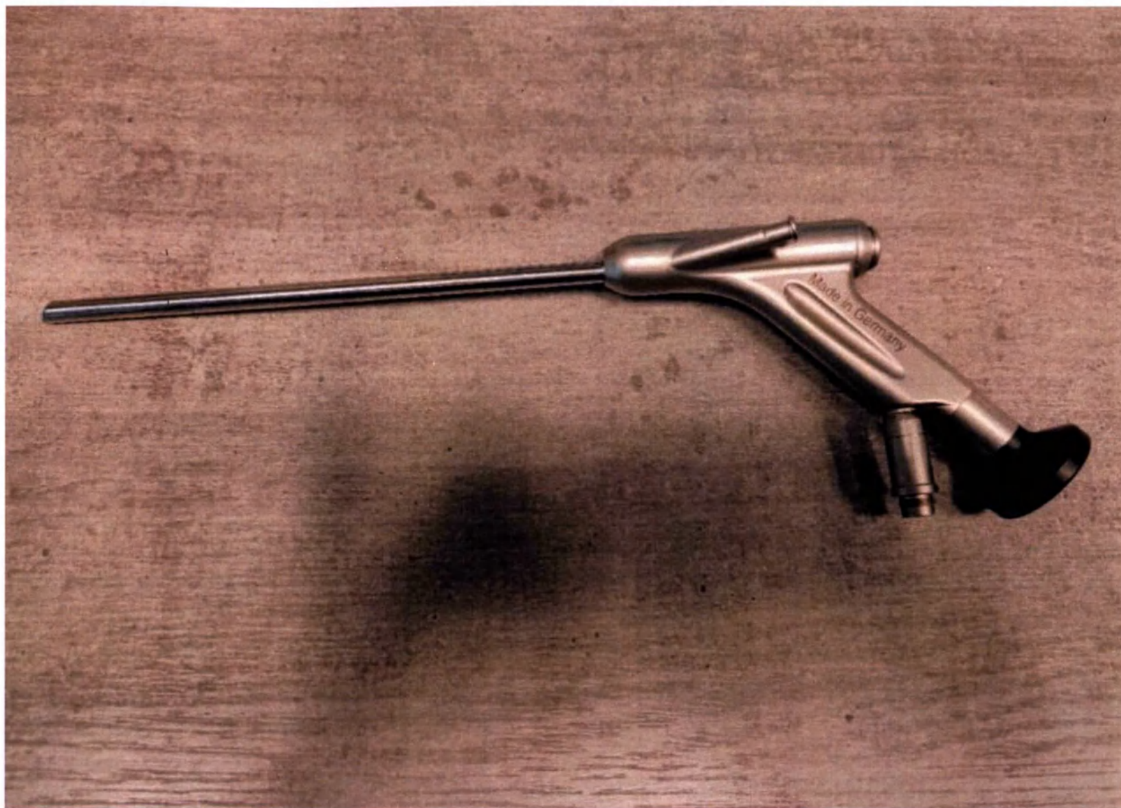
Фото 5. Эндоскоп жёсткий, угол направления наблюдения 30°, диаметр 7,6 мм, длина 166 мм
