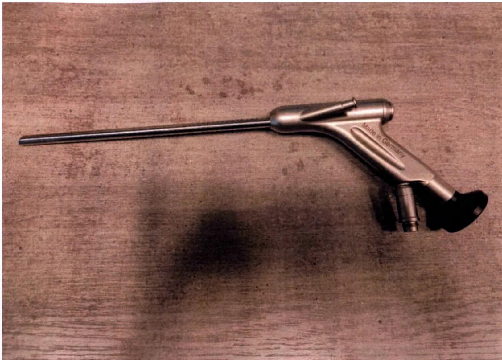
Фото 6. Эндоскоп жёсткий, угол направления наблюдения 20^{\circ} , диаметр 10,6 мм, длина 135 мм
