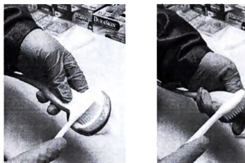
Рис. 11-5. Чистка датчика щеткой
