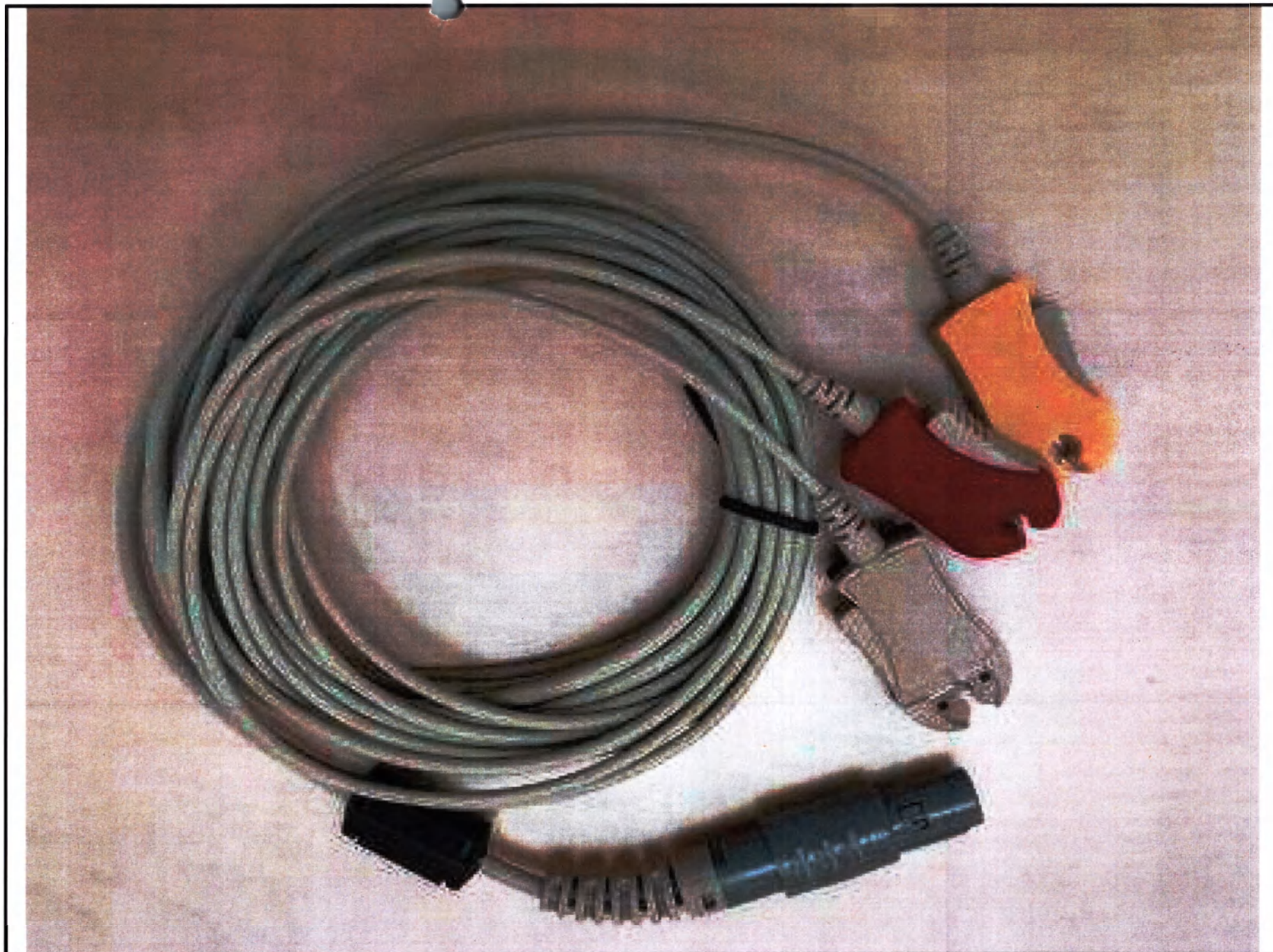
Устройство ECG-USB1, обеспечивающее регистрацию физиологических сигналов ЭКГ. Кабель пациента
