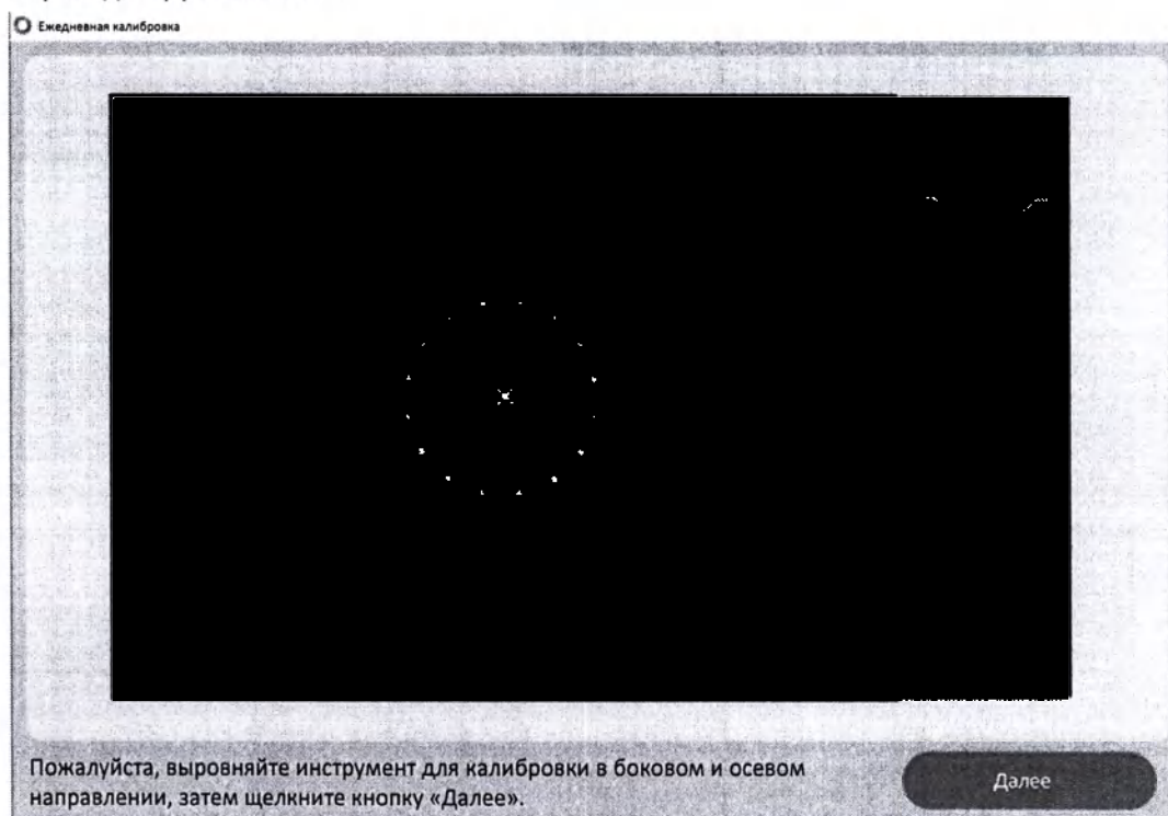
Рис. 92 Изображение программы при успешно выполненном боковом выравнивании с характеристическим зеркальным отражением (вертикальной белой линией) на ОКТ изображении.
