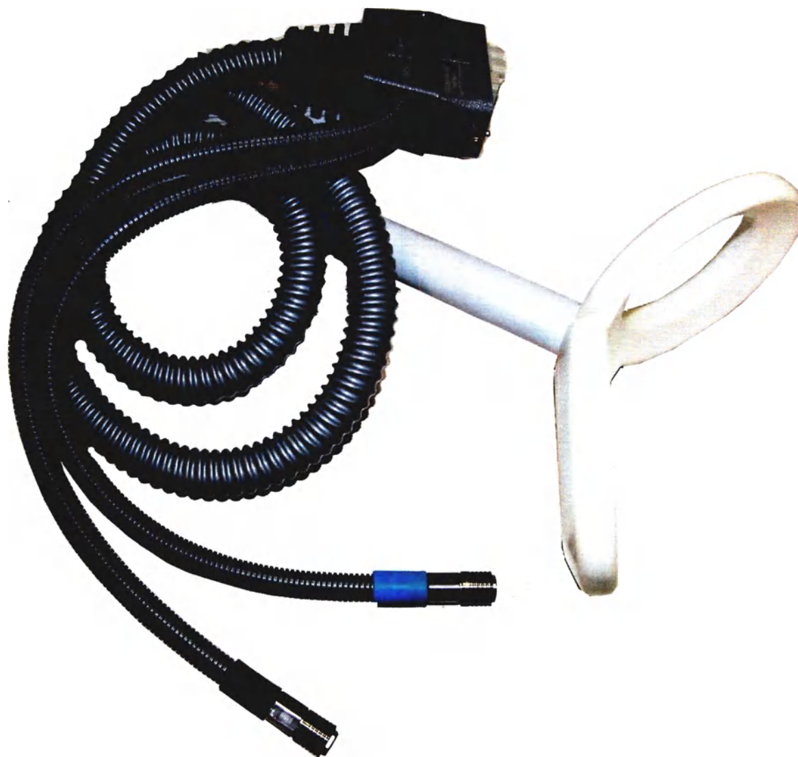
Индуктор двойной конический охлаждаемый «ИДК-03-125-О», NS063304.017
