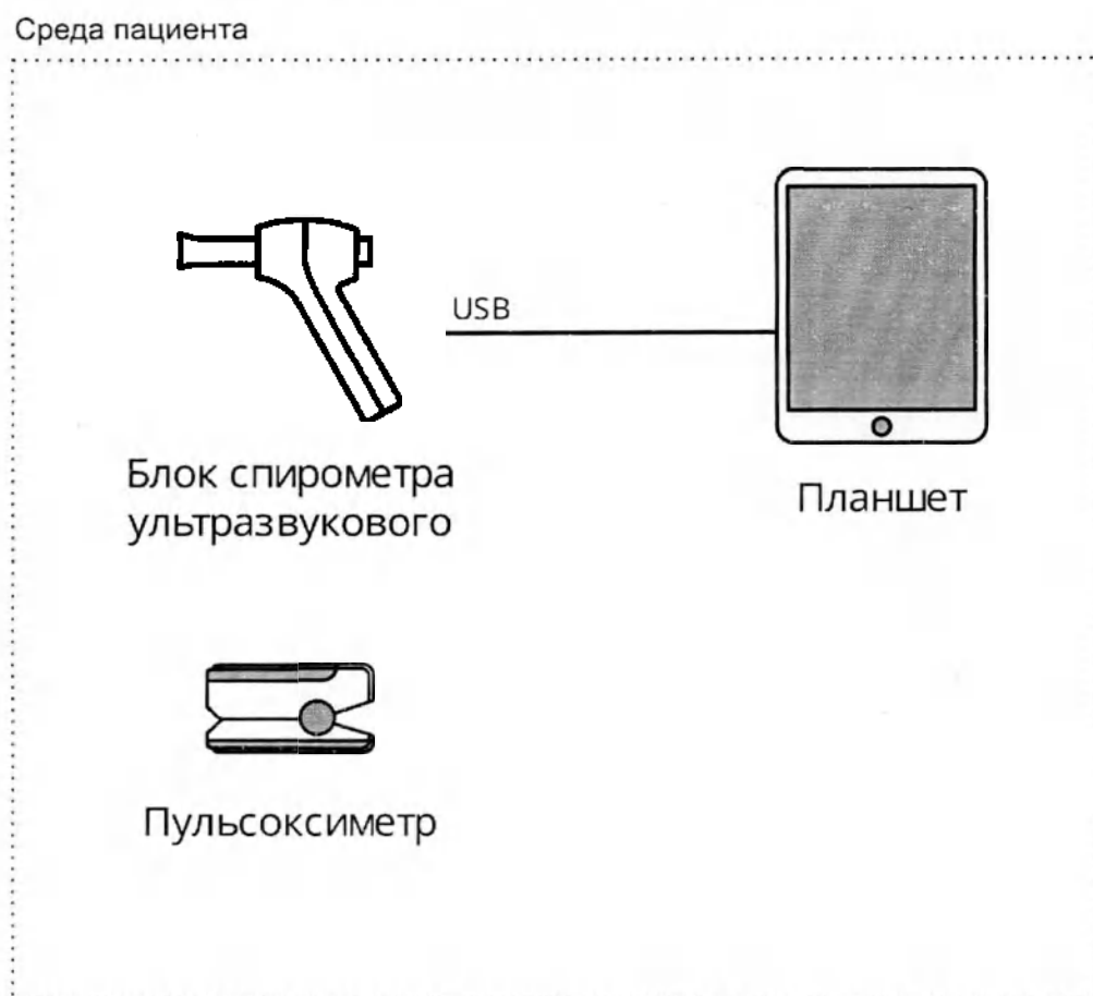
Рис. 12. Схема подключения спирометра к планшету по кабелю USB
