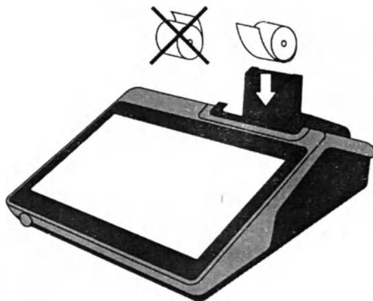
Рис. 6. Установка рулона термобумаги в ложемент принтера
