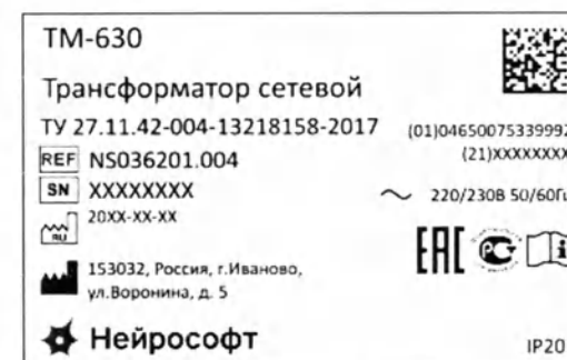
Рис. 4. Образец маркировки трансформатора
