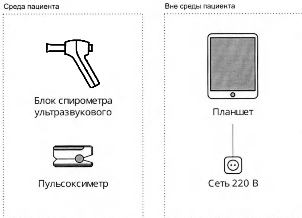
Рис. 11. Схема подключения спирометра к планшету по Bluetooth
