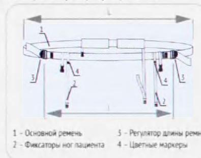
Рис. 2 Ременное устройство для переноса пострадавших РУП-«МЕДПЛАНТ»
