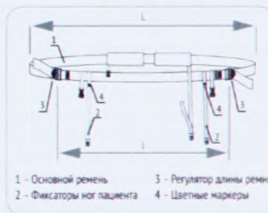
Рис. 2 Ременное устройство для переноса пострадавших РУП-«МЕДПЛАНТ»
