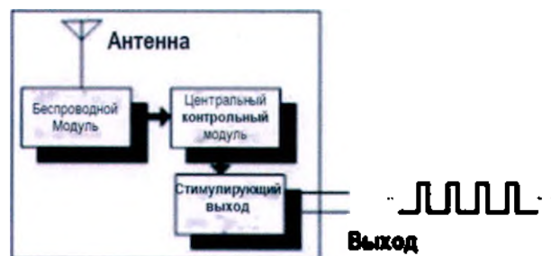
Рисунок 2. Функциональная схема стимулятора
