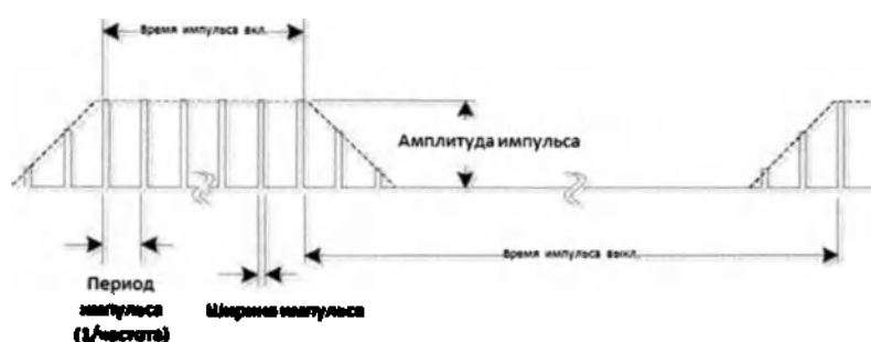
Рисунок 4. Контур импульса и параметры
