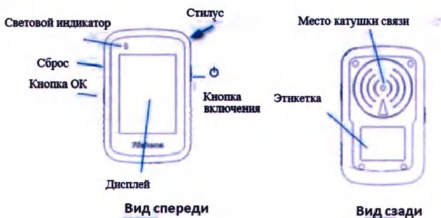
Рисунок 1. Вид VP213A спереди и сзади
