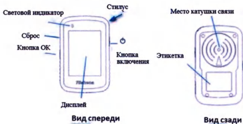
Рисунок 1. Вид программатора VP213B спереди и сзади
