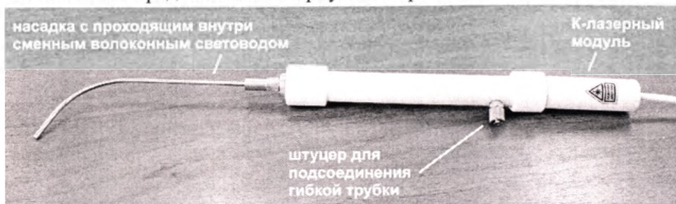
Рис.11. Инструмент для сочетанного воздействия струёй рабочего раствора и К-лазерного излучения (Инструмент 1).
