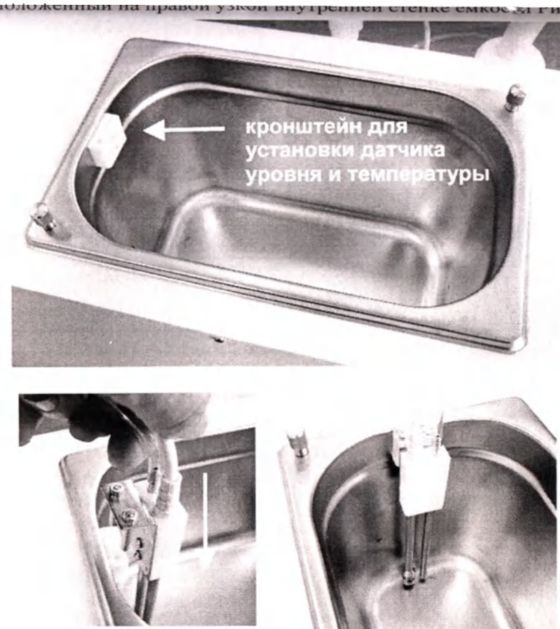
Рис.7. Установка датчика уровня и температуры рабочего раствора
