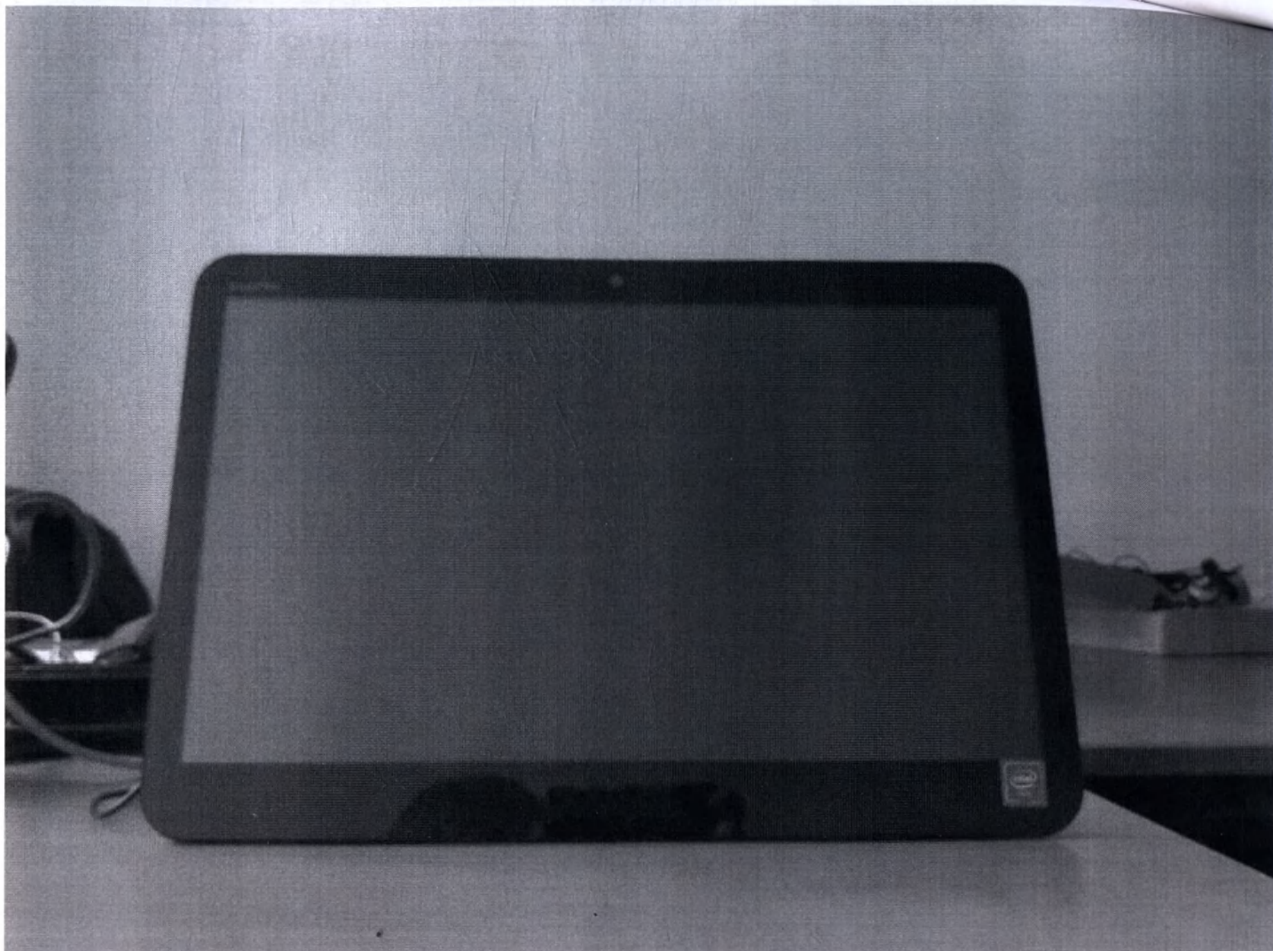
Прибор для комплексной аппаратно-программной обработки, сохранения, приёма и передачи физиологических параметров человека «ТачМед» (TouchMed) по ТУ 32.50.50-001-11354155-2019, исполнение ОТМ (на базе ПК) с предустановленным программным обеспечением
