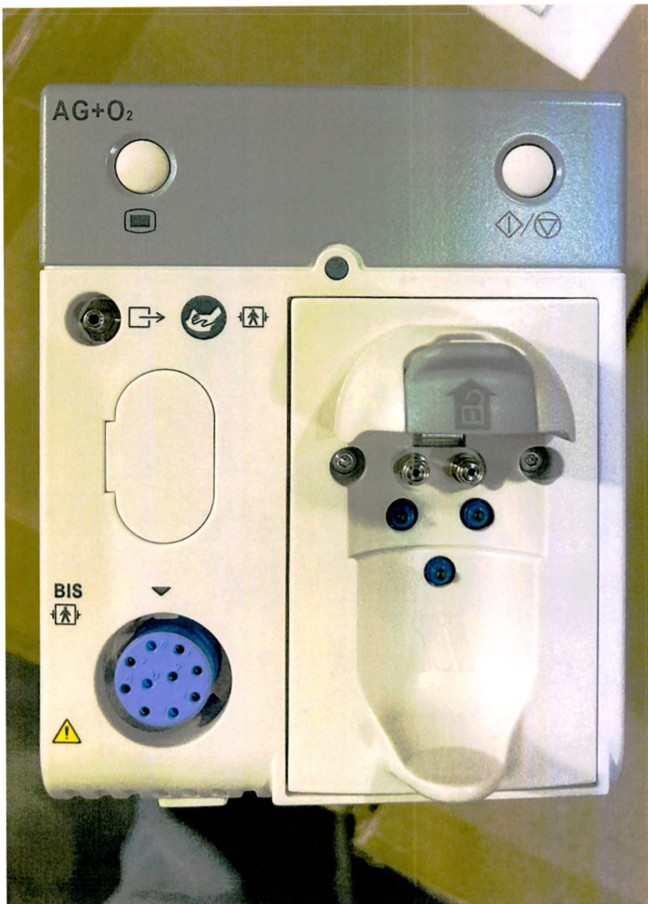
62. Модуль газоанализа с парамагнитным датчиком кислорода и с BIS.
