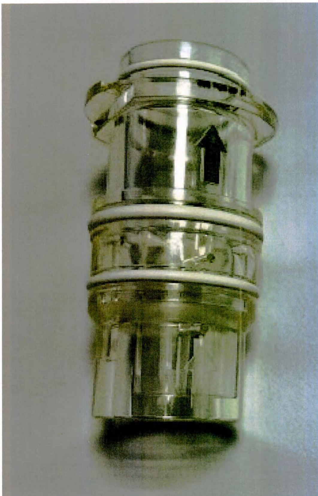
49. Датчик потока инспираторный, автоклавируемый.
