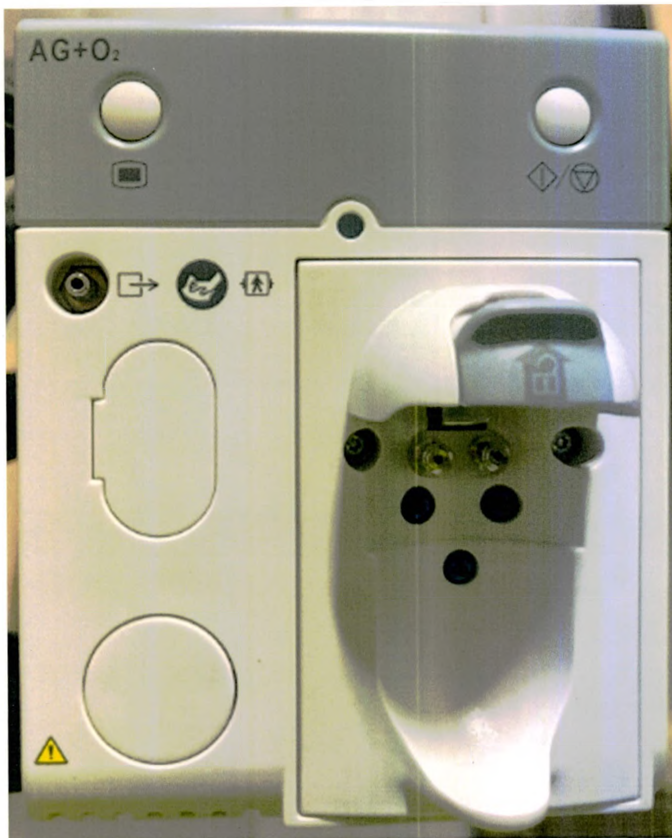
60. Модуль газоанализа с парамагнитным датчиком кислорода.
