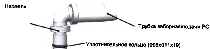
Рис.13 Место посадки кольца уплотнительного (008x011x19) на ниппеле.
