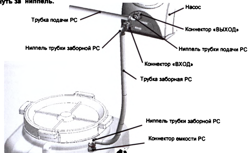
Рис.12 Подключение трубки подачи РС и трубки заборной РС
