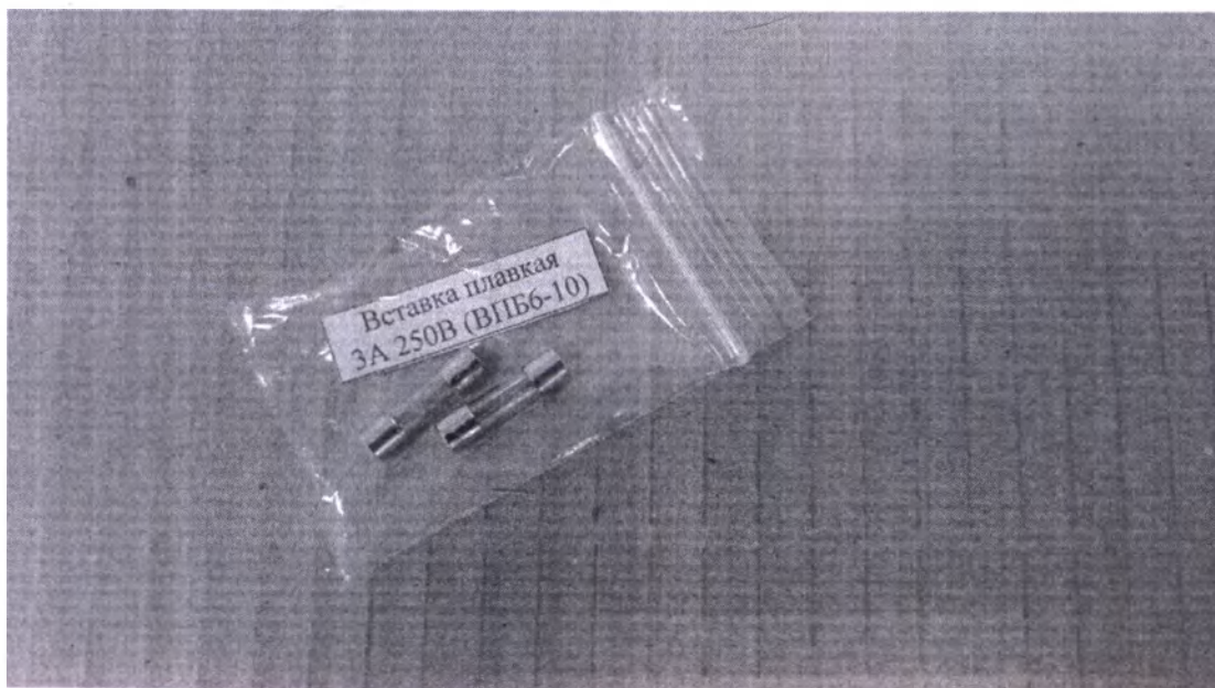
Фотография 49. Принадлежность Вставка плавкая (предохранитель) 3 А 250В (ВПБ6-10)
