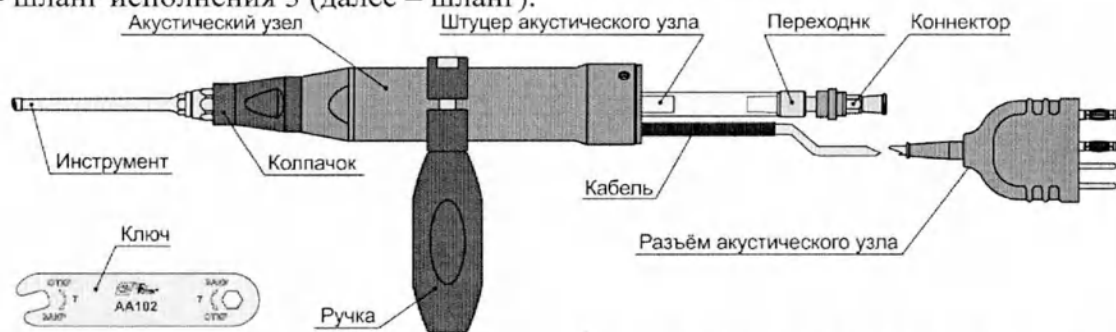
Рисунок 8 – Узел акустический ультразвуковой с возможностью установки сменного инструмента. Исполнения 1 и 2. В сборе с составными частями для аппарата моделей «ACTITON-A» и «ACTITON»
