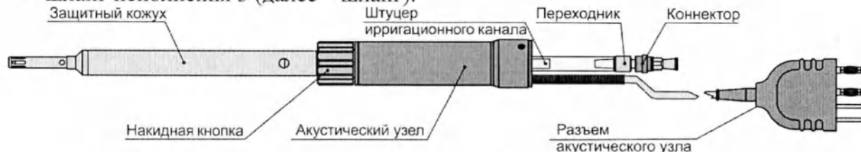
Рисунок 14 – Узел акустический ультразвуковой с защитным кожухом. Исполнение 1. В сборе для аппарата моделей «ACTITON-A» и «ACTITON»
