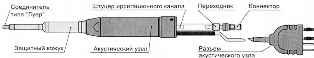
Рисунок 23 – Узел акустический ультразвуковой со сменным защитным кожухом. Исполнение 3. В сборе для аппарата моделей «АСТИТОН-А» и «АСТИТОН». Кожух сменный исполнения 3.
