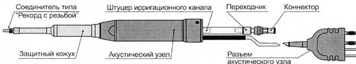
Рисунок 24 – Узел акустический ультразвуковой со сменным защитным кожухом. Исполнение 4. В сборе для аппарата моделей «АСТИТОН-А» и «АСТИТОН». Кожух сменный исполнения 4.
