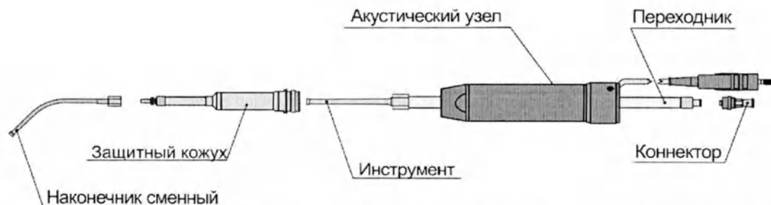
Рисунок 25а – Сборка узла акустического ультразвукового со сменным защитным кожухом в исполнении 4.
