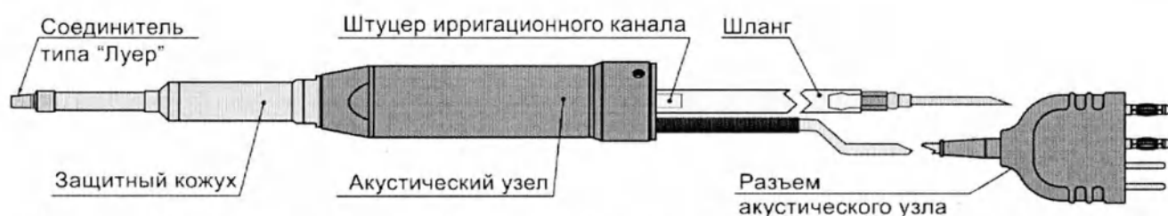
Рисунок 23а – Узел акустический ультразвуковой со сменным защитным кожухом. Исполнение 3. В сборе для аппарата моделей «АСТИТОН-АВ» и «АСТИТОН-В». Кожух сменный исполнения 3.
