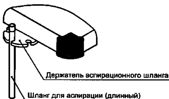
Рисунок 44 – Установка шланга для аспирации в держатель аспирационного шланга на полке передвижной стойки
