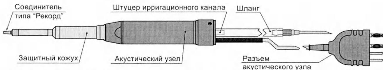
Рисунок 22а – Узел акустический ультразвуковой со сменным защитным кожухом. Исполнение 2. В сборе для аппарата моделей «АСТИТОН-АВ» и «АСТИТОН-В». Кожух сменный исполнения 2.
