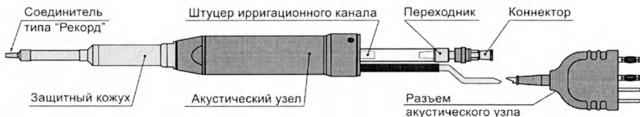
Рисунок 22 – Узел акустический ультразвуковой со сменным защитным кожухом. Исполнение 2. В сборе для аппарата моделей «АСТИТОН-А» и «АСТИТОН». Кожух сменный исполнения 2.
