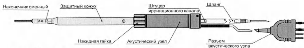
Рисунок 17а – Узел акустический ультразвуковой с защитным кожухом. Исполнение 3. В сборе для аппарата моделей «ACTITON-AB» и «ACTITON-B».
