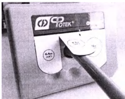
Рисунок 13 – Присоединение шланга аспирационного к фильтру сменному
