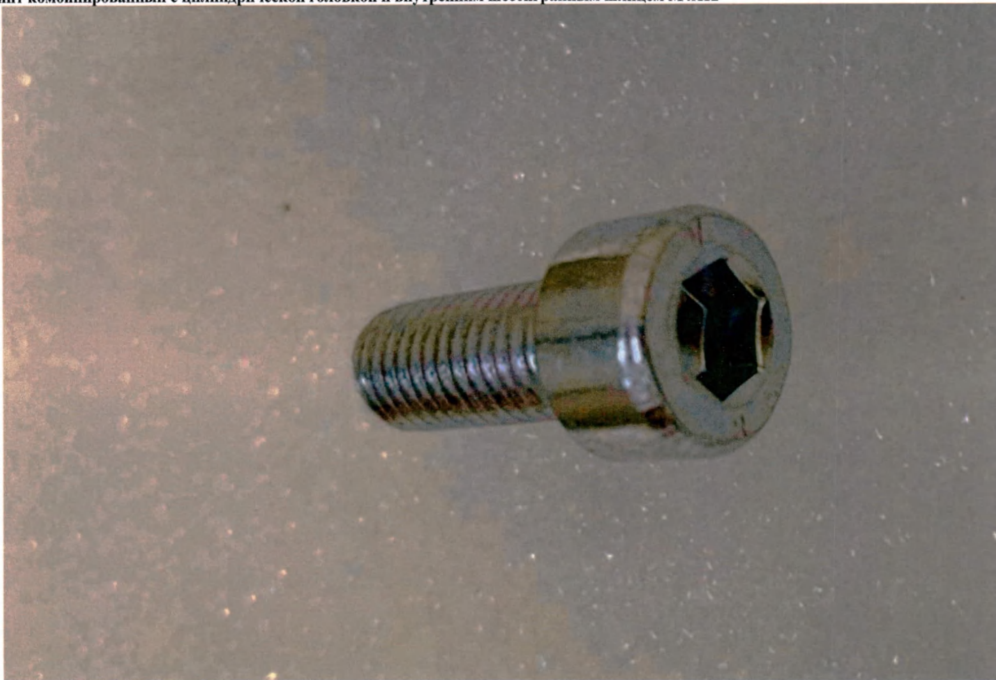
Винт комбинированный с цилиндрической головкой и внутренним шестигранным шлицем М4Х12
