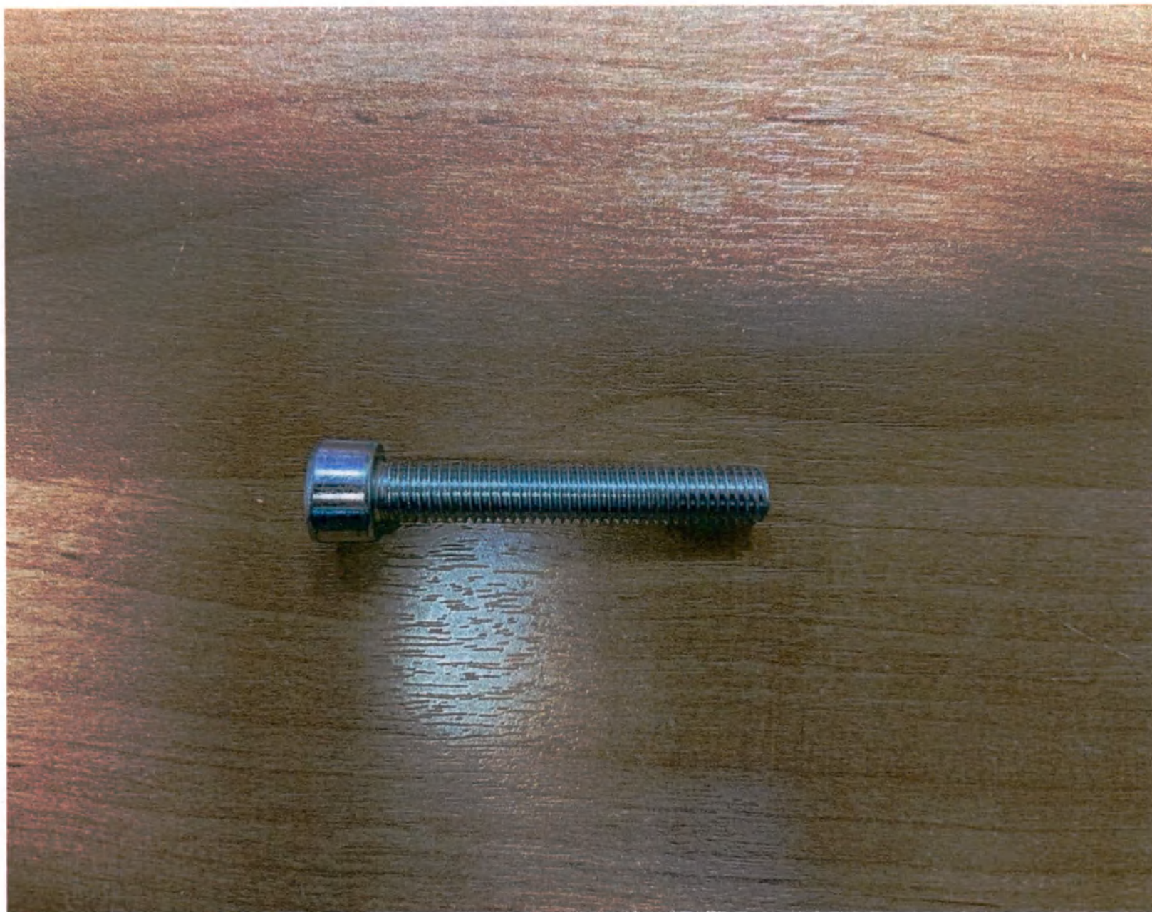
Винт с цилиндрической головкой и внутренним шестигранным шлицем M8X50
