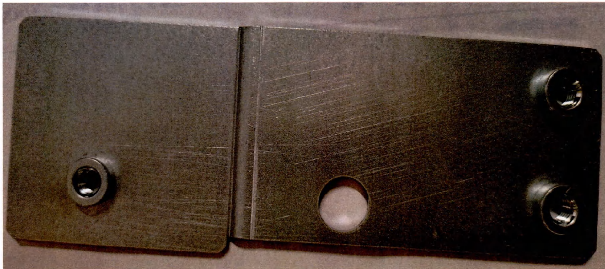
Кронштейн для защитного кожуха автозагрузчика
