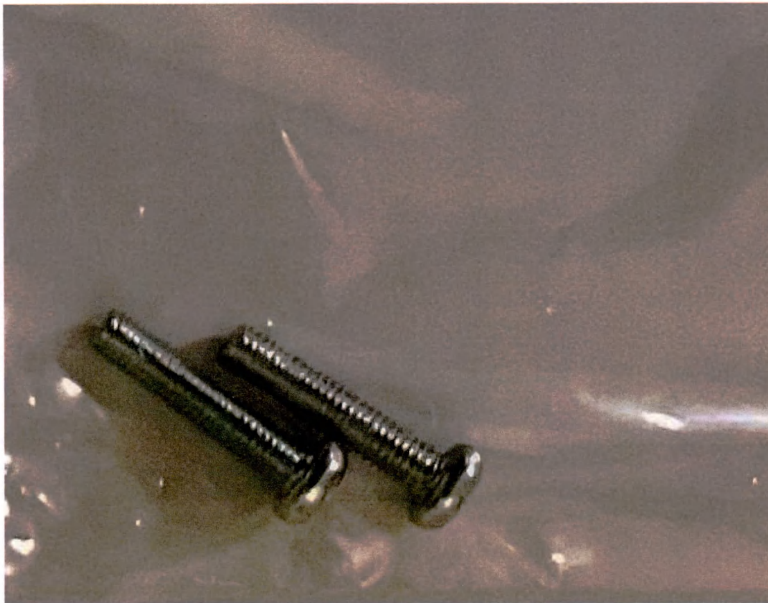
Винт с полукруглой головкой и крестообразным шлицем М4Х6
