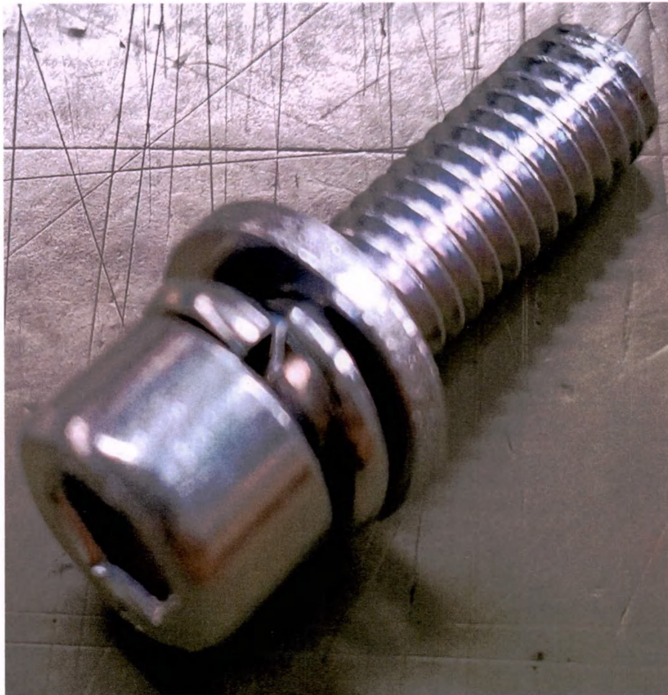
Винт с цилиндрической головкой и внутренним шестигранным шлицем М4Х20
