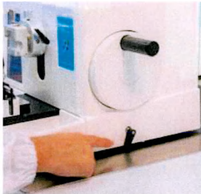
РЫЧАГ К ОПЕРАТОРУ: МАХОВИК ЗАБЛОКИРОВАН
