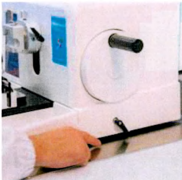
РЫЧАГ ОТ ОПЕРАТОРА: МАХОВИК РАЗБЛОКИРОВАН
