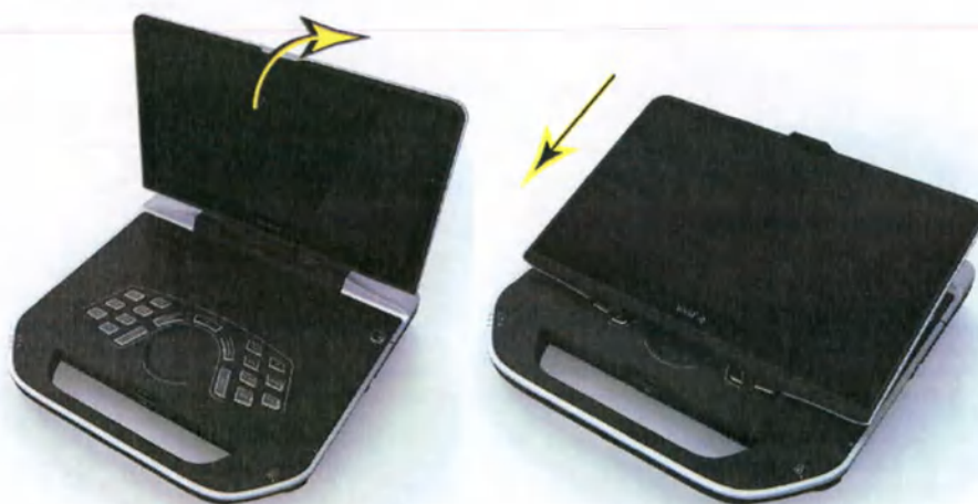
Рис. 3-11. Регулировка положения ЖК-монитора вверх/вниз
