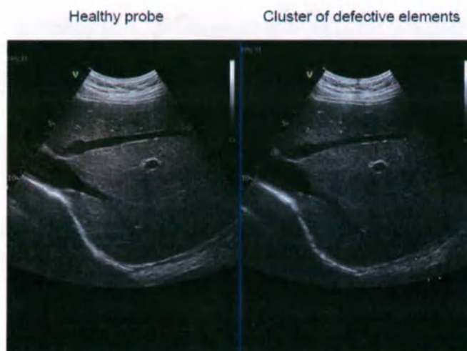
Рис. 12-27. Пример снижения качества изображения, полученного с помощью конвексного датчика
