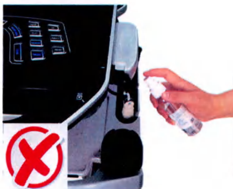
Рис. 14-1. НЕ опрыскивайте датчик, находящийся в держателе
