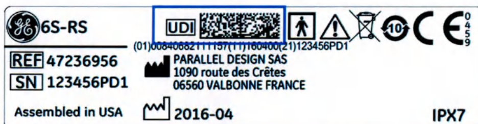
Рис. 2-12. Расположение кода GTIN и штрихкода на этикетке с уникальным идентификатором (UDI) датчика
