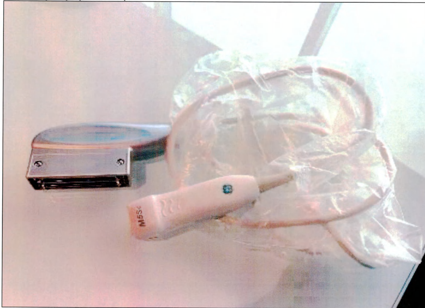
Датчик секторный фазированный матричный M5Sc-RS.
