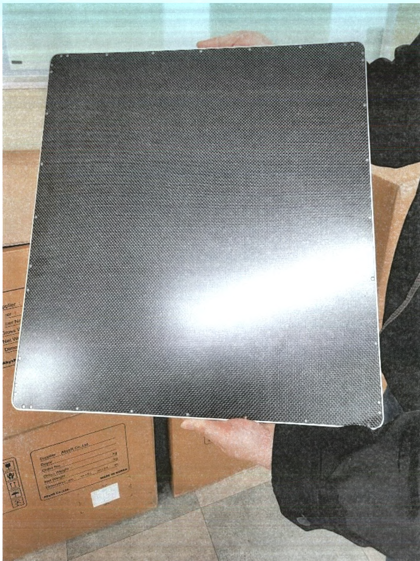
Фотография 21 - Детектор цифровой рентгеновский плоскостельный серии ASTEL Inc., Республика Корея, серии RFA-1717DIC, ASTEL Inc, SN: RCSB2308016ASTEL (вариант внешнего вида со стороны сенсора)
