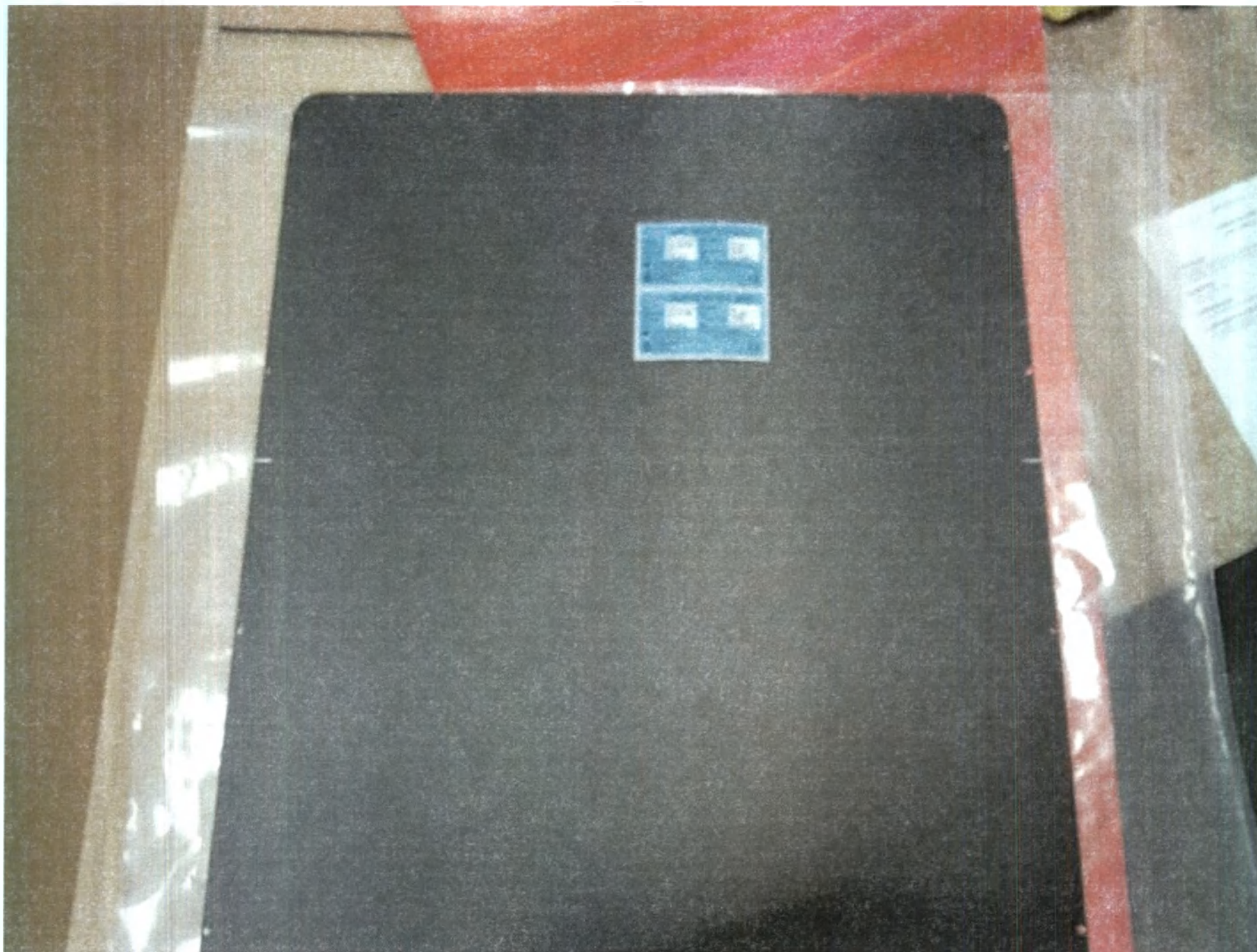
Фотография 23 - Решетка фокусирующая (растр рентгеновский). Вариант внешнего вида
