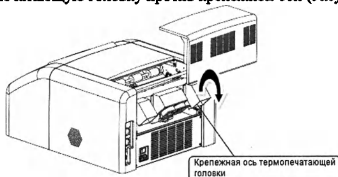
Рисунок 30 – Демонтаж термопечатающей головки
