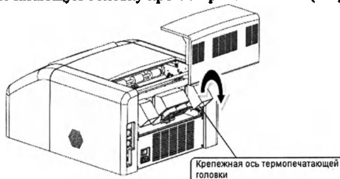
Рисунок 27 – Демонтаж термопечатающей головки
