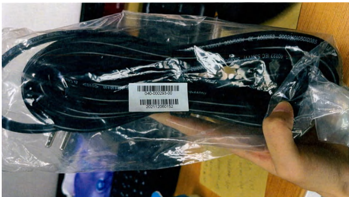
Рис. 2.2.47. Кабель питания для компрессора воздуха
