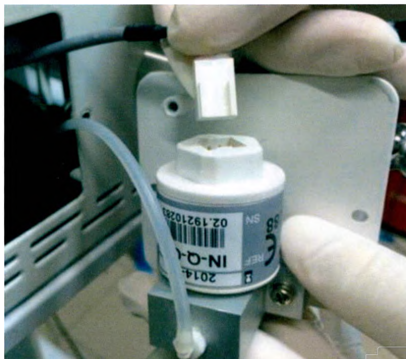
Рис. 11.6.3. Отсоединения провода блока основного от датчика кислорода
