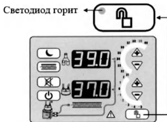
Рис. 2.6.3. Разблокировка увлажнителя воздуха VN-3000
