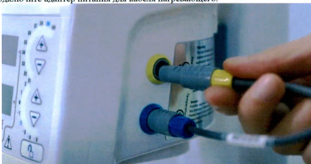
Рис. 5.1.38. Подключение адаптера питания для кабеля нагревающего к увлажнителю воздуха VH-3000
