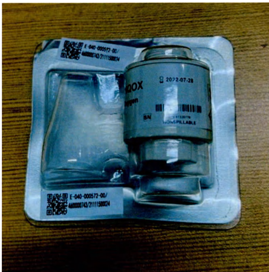
Рис. 2.2.17. Датчик кислорода, модель INQOX, производитель ElviteC-Wismar GmbH
