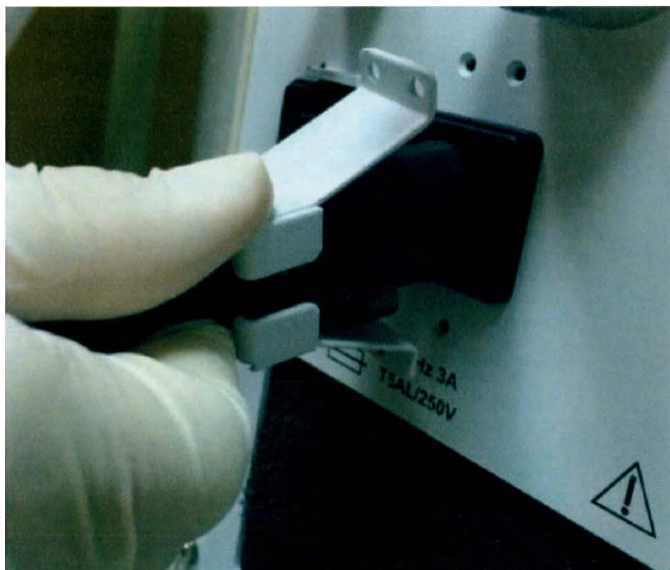
Рис. 5.1.18. Подключение кабеля питания к компрессору воздуха VS-20
