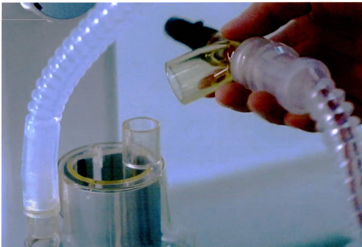
Рис. 5.1.34. Подключение кабеля нагревающего к камере водяной многоразовой
