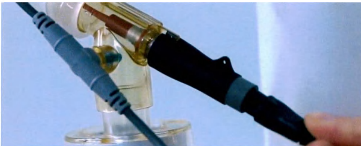
Рис. 5.1.39. Подключение адаптера питания для кабеля нагревающего к коннектору 3P/2P 14. Подключите трубку давления к блоку основному, как показано на рисунке.
