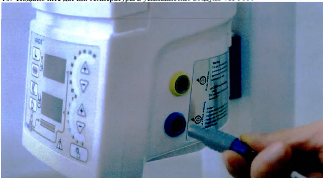
Рис. 5.1.35. Подключение датчика температуры к увлажнителю воздуха VH-3000
