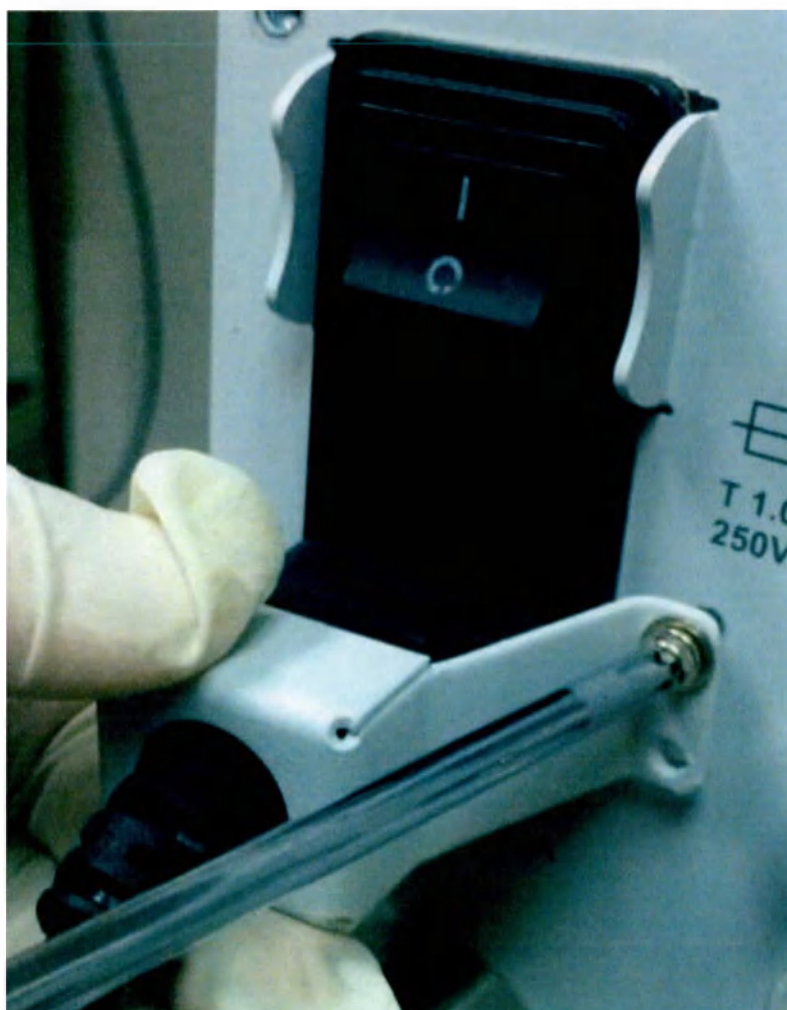
Рис. 5.1.15. Закрепление кабеля питания
