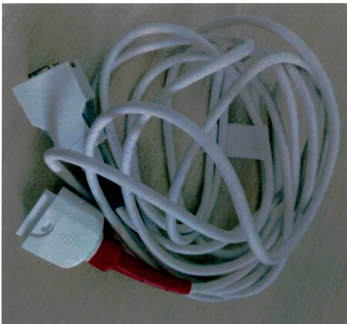
Удлинитель кабеля питания SpO 2 , модель M-LNC - 10, производитель Masimo Corporation
