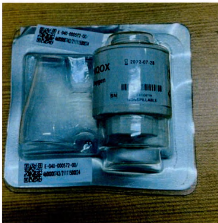
Датчик кислорода, модель INQOX, производитель EnviteC-Wismar GmbH
