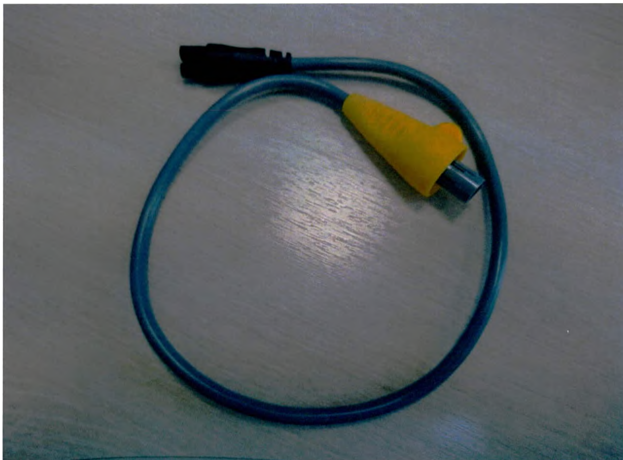
Адаптер питания для кабеля нагревающего, модель VH30100, производитель VADI Medical Technology Co., Ltd. Yangmei
