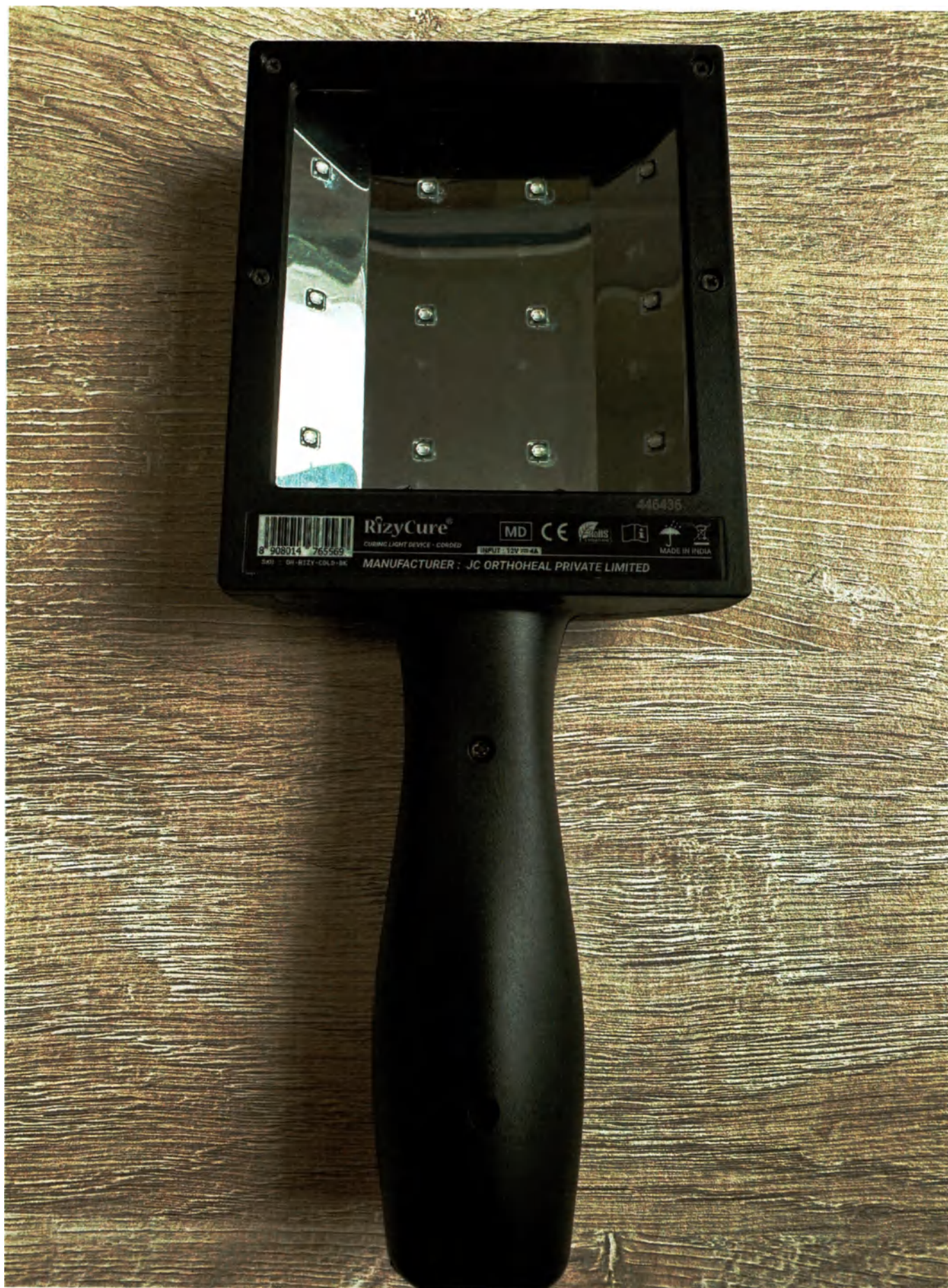
Рисунок 82. Устройство световое для полимеризации, проводное RzyCure® (Вид сверху)
