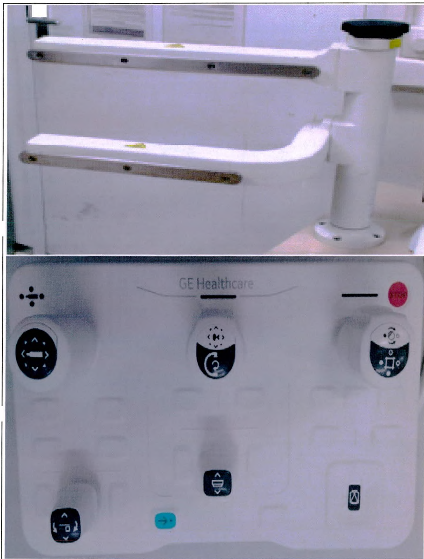
Рисунок 175. Удаленная панель управления ангиографической системой
