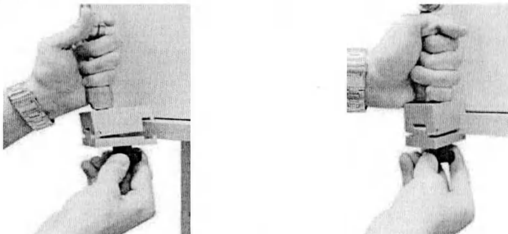
Рисунок 3.3 – Установка штанги держателя контура
