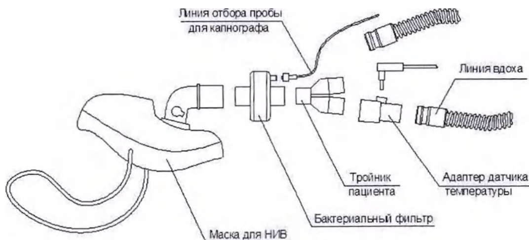
Рисунок 3.19 – Схема сборки дыхательного контура с маской для NIV
