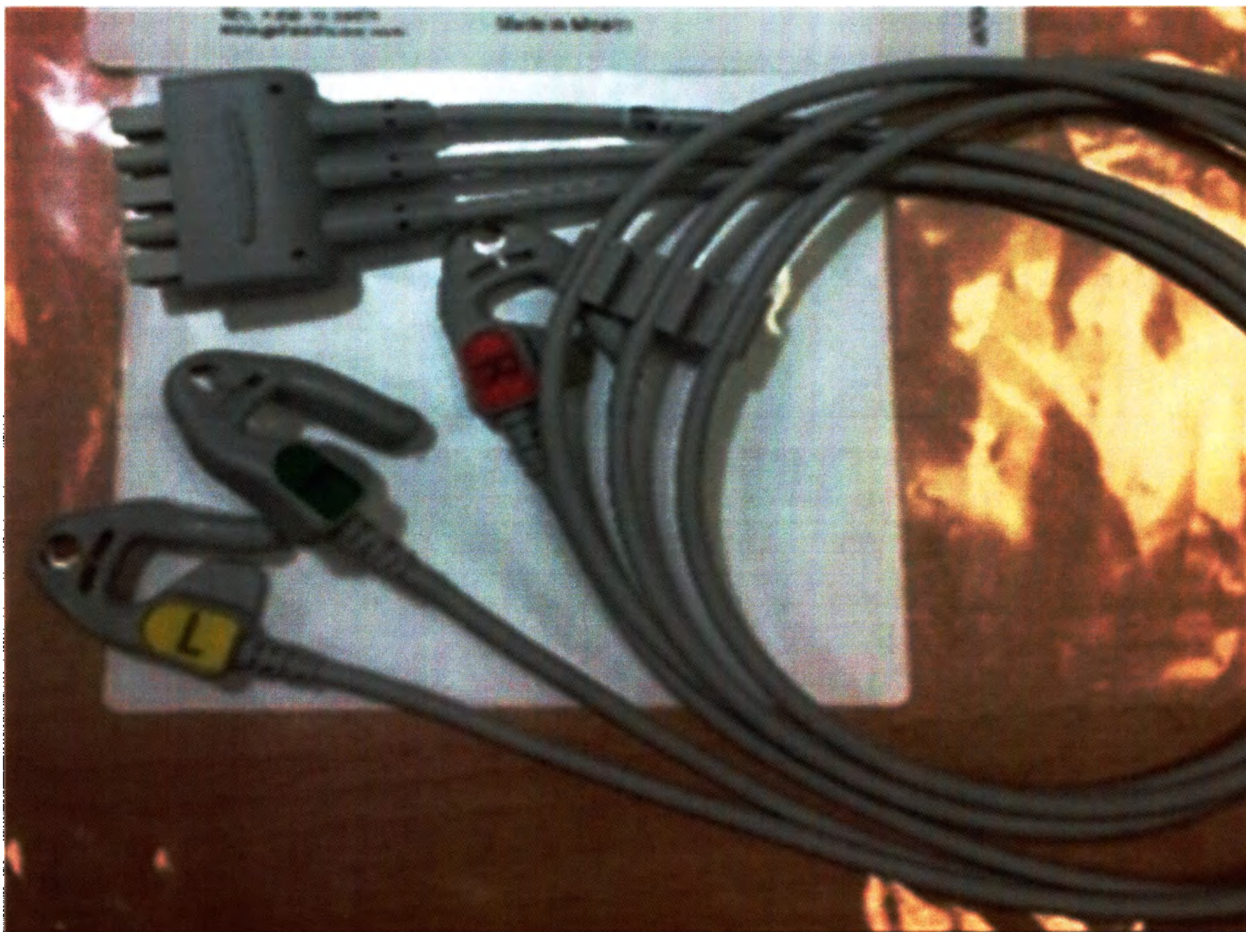
Рисунок 25. Устройство внешнее, обеспечивающее регистрацию физиологических сигналов ECG IEC.
