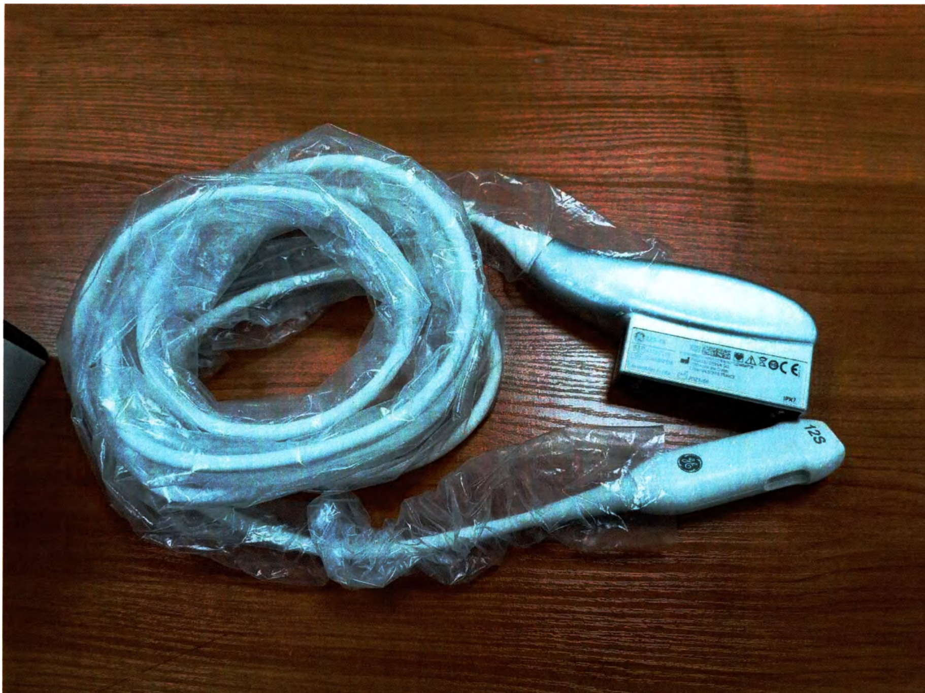
Рисунок 10. Датчик секторный фазированный 12S-RS.
