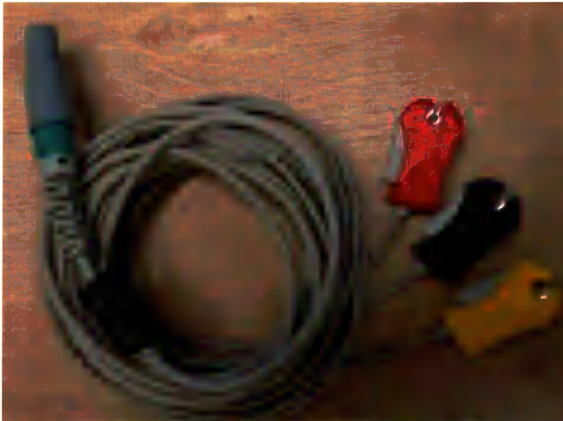
Рисунок 24. Устройство внешнее, обеспечивающее регистрацию физиологических сигналов ECG IEC.
