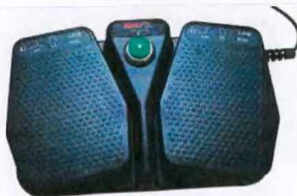
Рис. 2-26. Трехпедальный переключатель и USB-кабель
