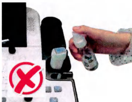
Рис. 13-1. НЕ опрыскивайте датчик, находящийся в держателе
