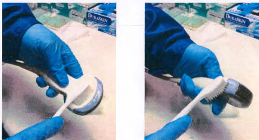
Рис. 11-12. Чистка датчика щеткой
