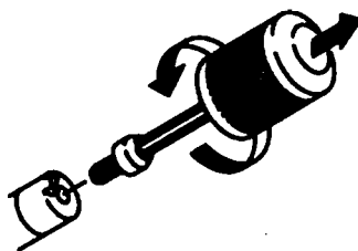
Рисунок 4. Повернуть стопорный винт против часовой стрелки
