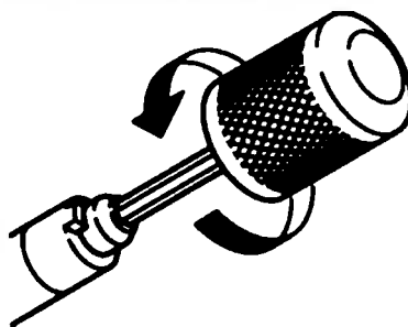
Рисунок 1. Поворот против часовой стрелки
