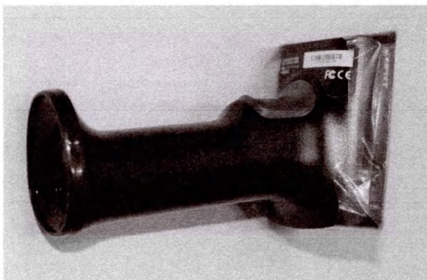
Рисунок 3 – Ручной сканер штрихкода (USB тип C, 2D, светодиодный)
