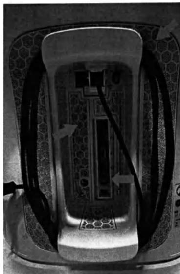
Рисунок 2-5 Воздушные фильтры и область вокруг разъемов на задней панели системы.
