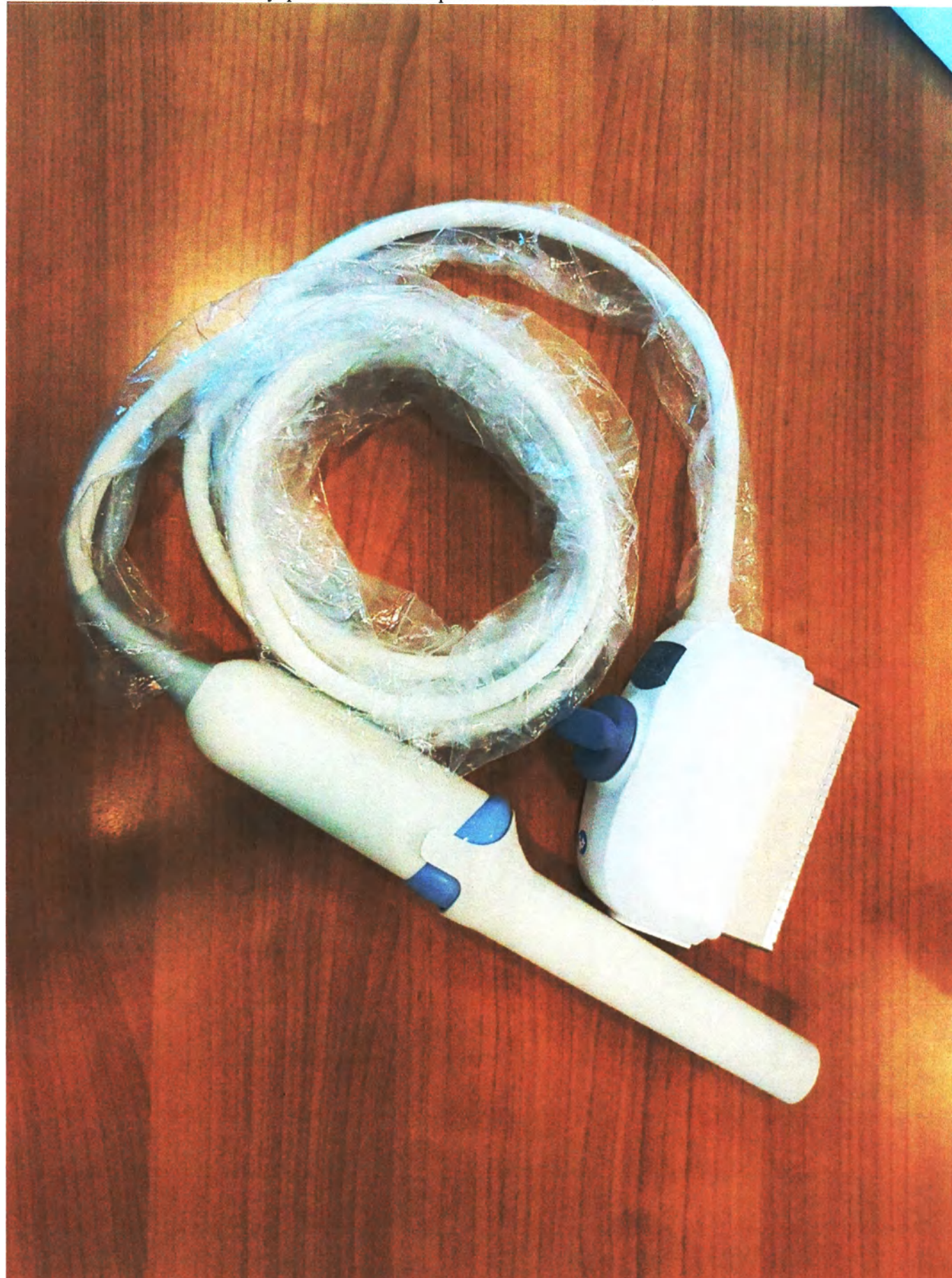
17. Датчик объемный внутриполостной микроконвексный RIC5-9-D.
