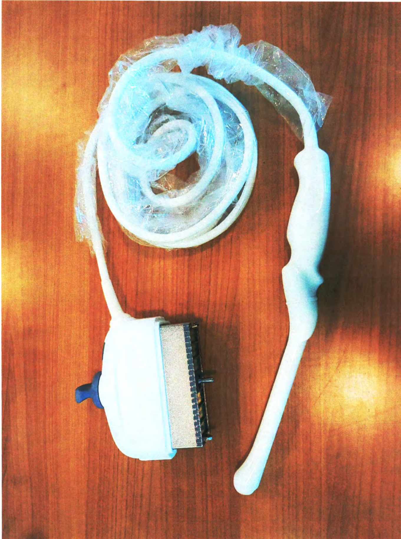
15. Датчик микроконвексный внутриполостной IC5-9-D.
