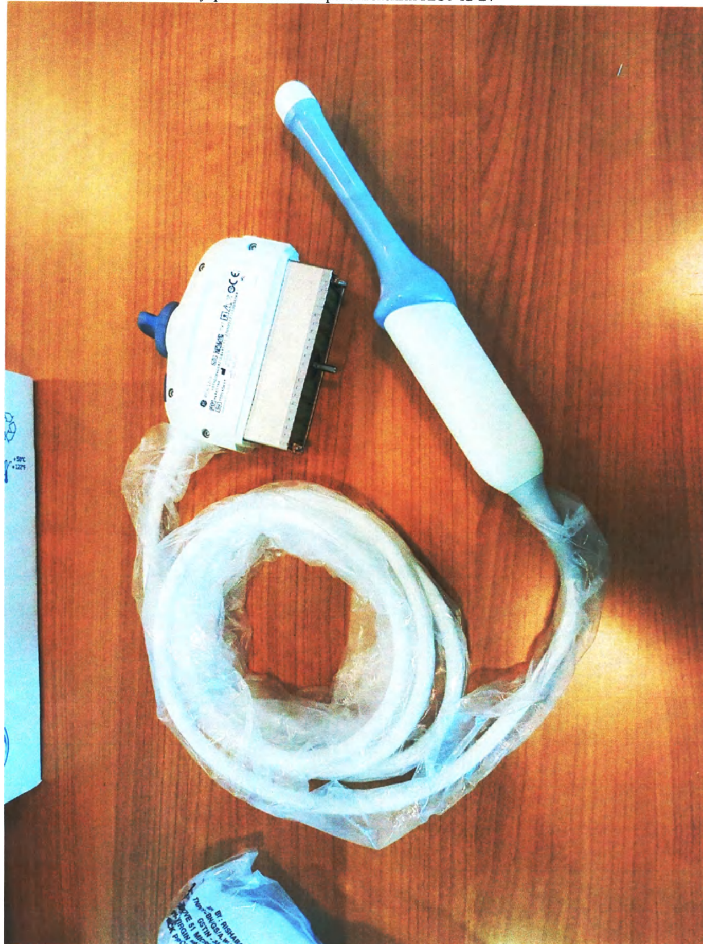
21. Датчик объемный внутриполостной микроконвексный RIC6-12-D.
