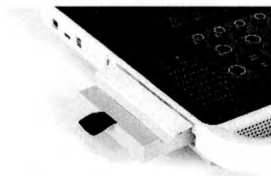
Установка аккумулятора в основной блок системы
