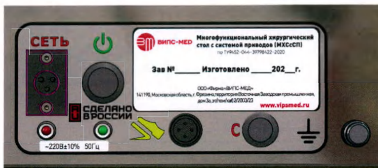
Рисунок 11 – Панель управления электрической системой МХСсСП (гнездо подключения сетевого кабеля, переключатель электрической системы управления) и зажимной контакт заземления
