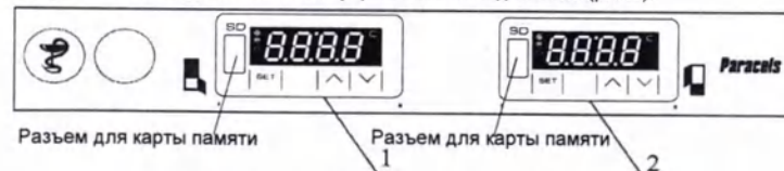
Рис.2 Схема расположения приборов управления 1 – контроллер морозильной камеры; 2 – контроллер холодильной камеры
