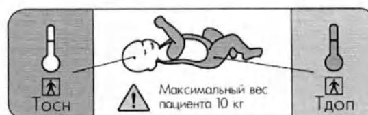
Рисунок 38 - Места крепления датчиков температуры кожи
