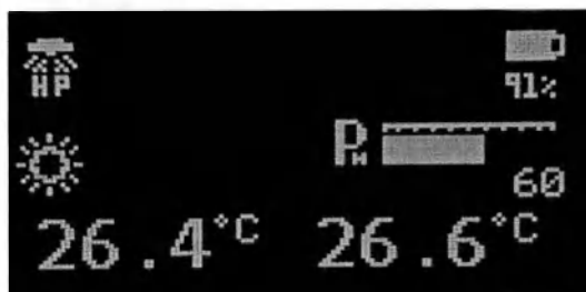
Рисунок 41 – Изображение дисплея в ручном режиме в дополнительном диапазоне мощности нагрева
