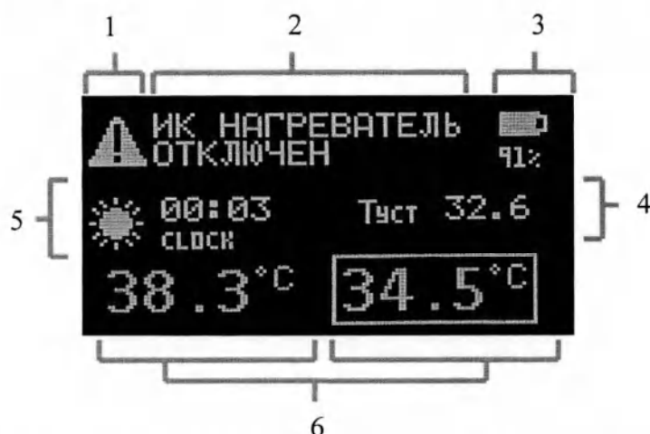
Рисунок 19 – Изображение дисплея панели управления модуля ИФК-излучателя
