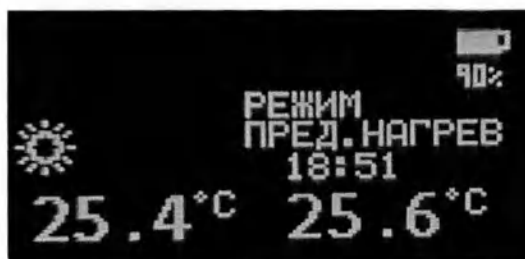
Рисунок 39 – Изображение дисплея в режиме предварительного нагрева
